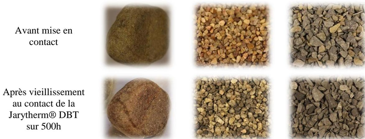
Figure 38 : Evolution de la couleur de certains matériaux après mise en contact avec l'huile Jarytherm® DBT et nettoyage à l'acétone – de gauche à droite : Roche, sable et quartzite
