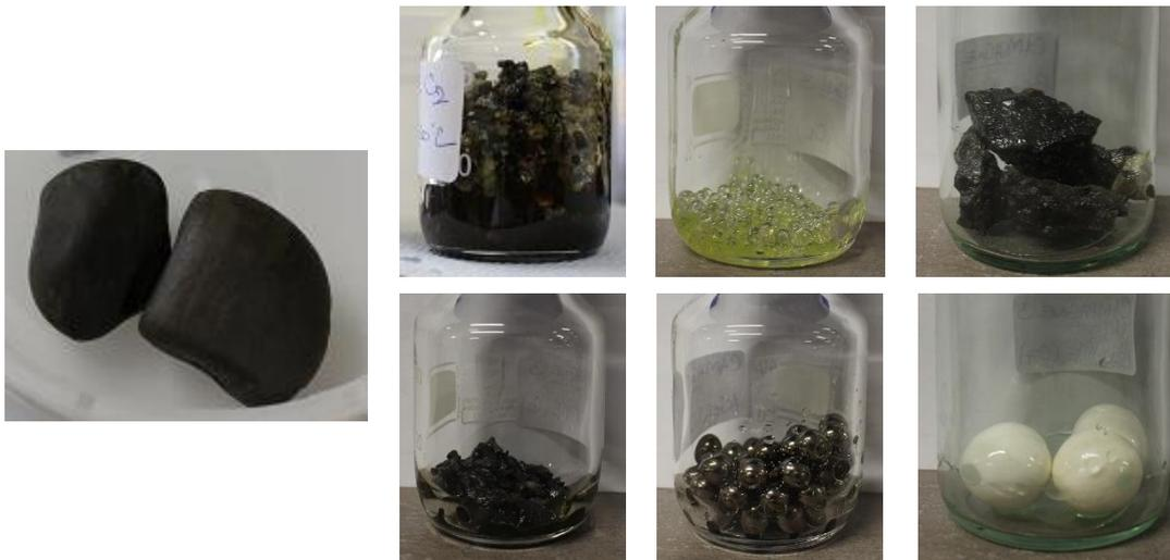
Figure 37 : Echantillons de solides collectés après les tests de compatibilité avec l'huile Jarytherm® DBT. De gauche à droite et de haut en bas : roches ; sable ; verre soda-lime ; béton ; quartzite ; acier et alumine
