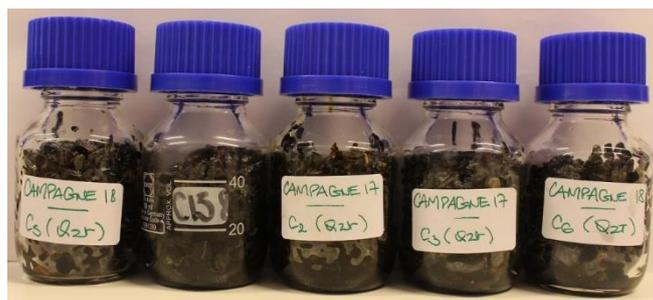
Figure 52 : Echantillons de quartzite collectés après vieillissement à 340°C au contact des différentes huiles – De gauche à droite : Dowtherm® G, DPDM® 400, Marlotherm® SH, Therminol® 66 et Therminol® 68
