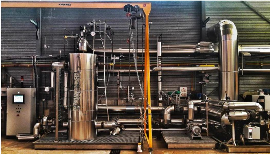
Figure 100 : Pilote de stockage thermocline dual-media développé par Bertin Technologies (site de Tarnos)
