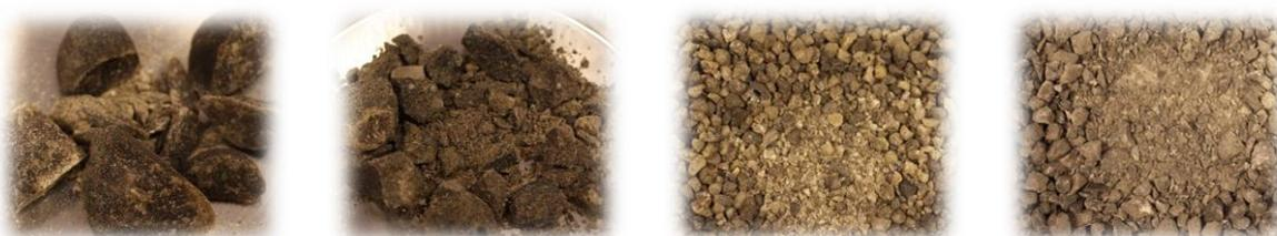
Figure 39 : Matériaux solides broyés après vieillissement au contact de l'huile Jarytherm® DBT – Roche, béton, sable et quartzite (de gauche à droite)
