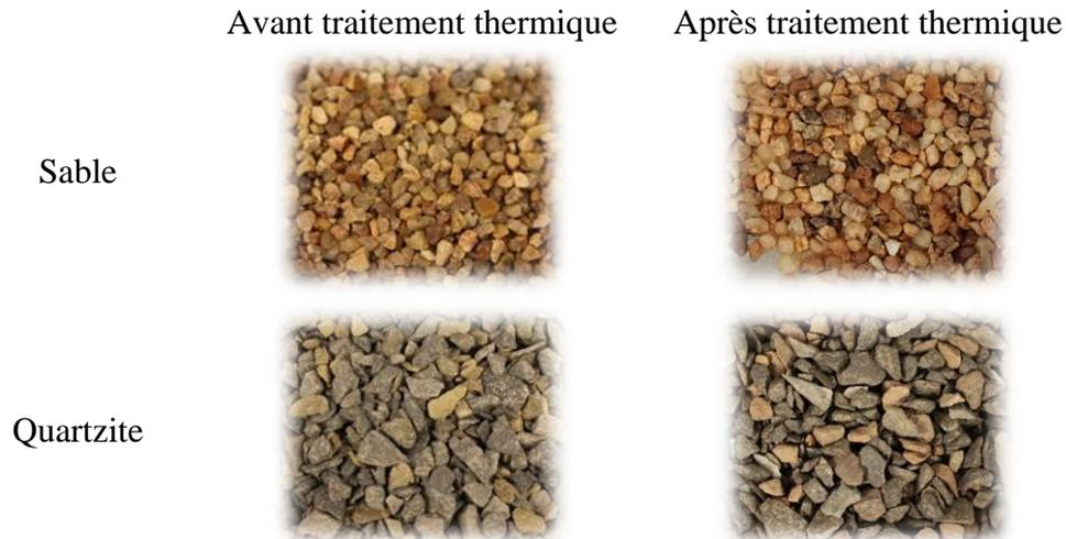
Figure 40 : Photographies des matériaux solides avant et après vieillissement sous air à 340°C pendant 3 semaines
