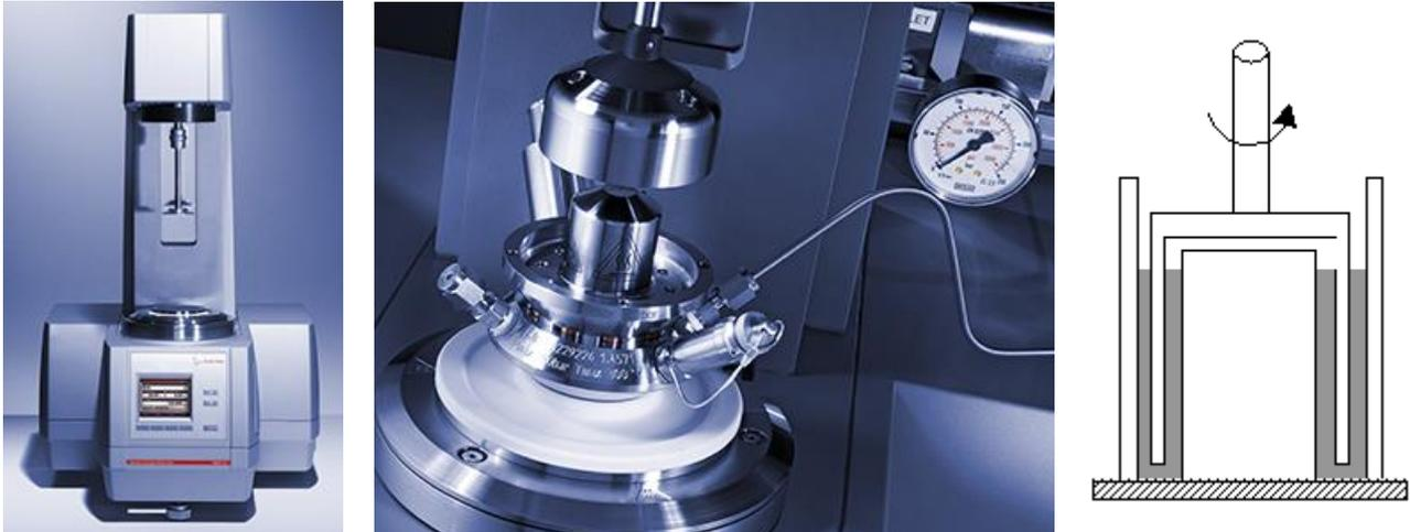
Figure 24 : De gauche à droite : Rhéomètre MCR302 ; Cellule haute-pression ; Géométrie Double-Gap
