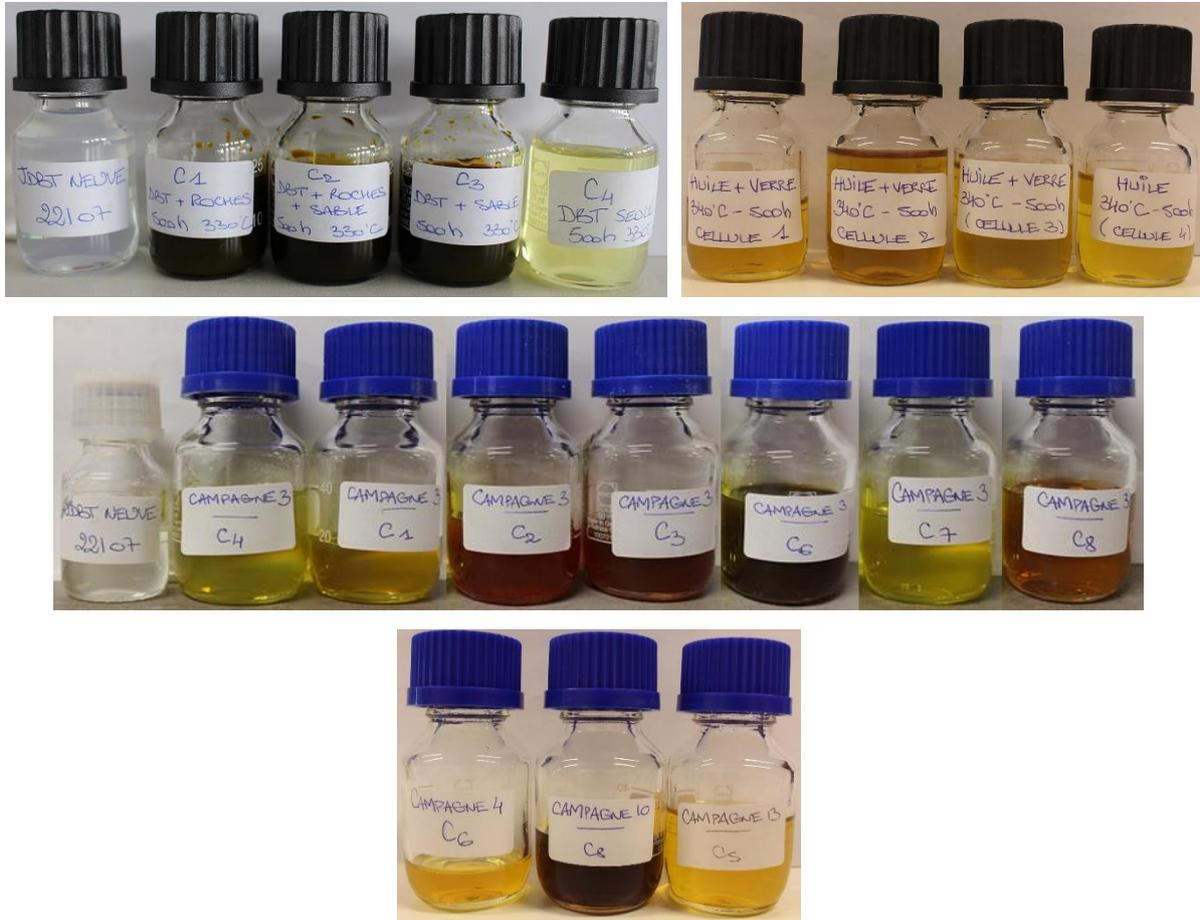
Figure 36 : Echantillons d'huile collectés après vieillissement sur les différentes campagnes d'essai présentées dans le tableau 3.
