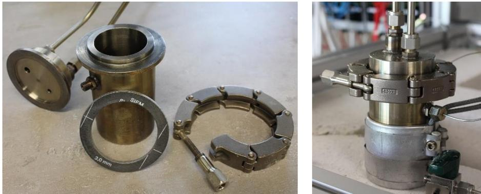
Figure 31 : Détail des composants du système d'étanchéité ; Vue d'une cellule de test montée
