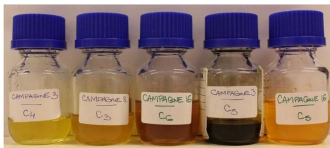
Figure 48 : Echantillons d'huile Jarytherm® DBT collectés après vieillissement à 340°C sur 500h – De gauche à droite : C3-4 (huile vieillie seule), C8-3 (SiO<sub>2</sub>), C16-6 (Al<sub>2</sub>O<sub>3</sub>), C3-5 (Fe<sub>2</sub>O<sub>3</sub>) et C16-6 (CaO)
