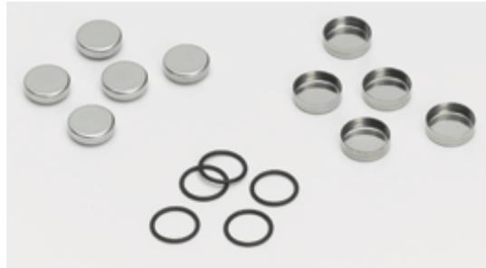
Figure 15 : À gauche, calorimètre Diamond, Perkin-Elmer ; à droite, capsules haute-pression en acier inoxydable
