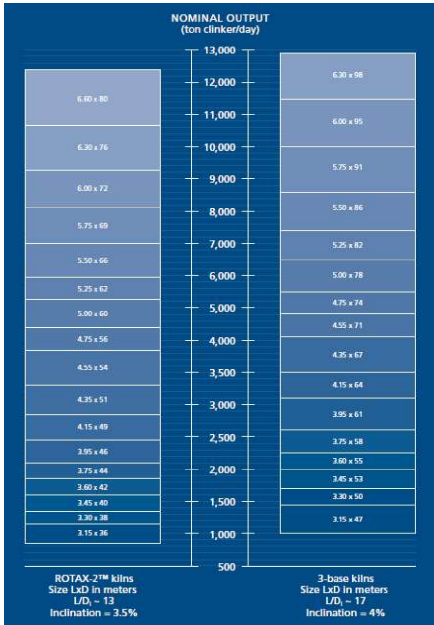
Figure 15 – Dimensions des fours tournant fabriqués par FLSmidth (FLSmidth, 2011).
