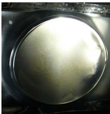
Miroir parabolique thermoformé à partir d'une parabole de télévision
