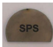
Figure II - 4 : Photographie d'un échantillon de spinnelle \text{MgAl}_2\text{O}_4 préparé par SPS [29].
