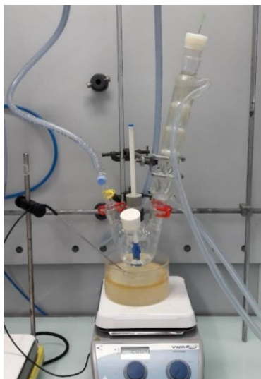
Figure 62 : Montage expérimental pour la réaction de silanisation
