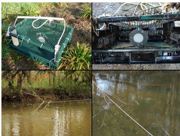
Figure II.29 : Échantillonneurs passifs (POCIS et o-DGT) installés dans une cage.
