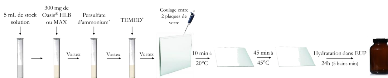
Figure II.13 : Protocole de fabrication de gels récepteurs à base de polyacrylamide (*30 et 65 µL de persulfate d'ammonium et 7,5 et 25 µL de TEMED respectivement pour le gel en Oasis® HLB ou Oasis® MAX).
