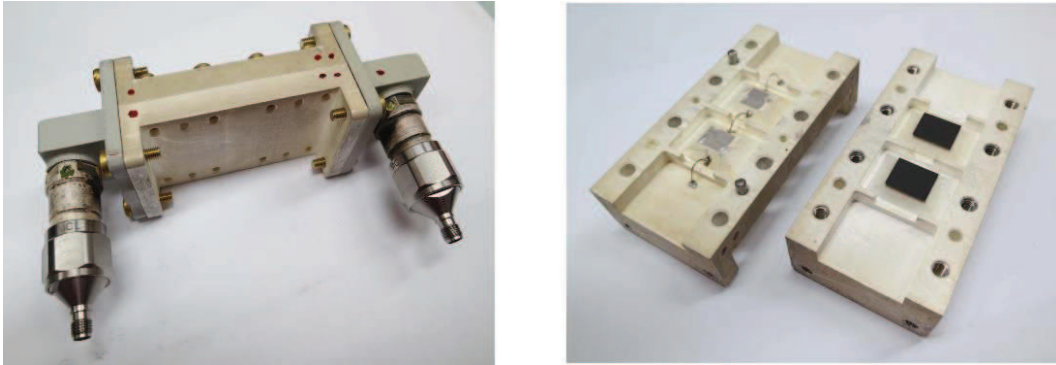
Figure I.28 : Filtre à cavités rectangulaires en bande X [33]
