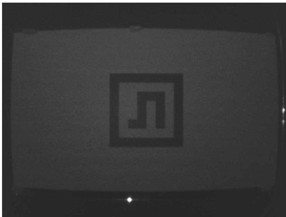
FIGURE 24 – Distorsion dans le SR300 IR. Le panneau avec le motif est rectangulaire.
