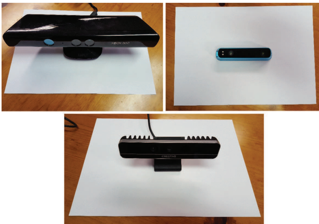
FIGURE 9 – Exemples de caméras 3D à lumière structurée grand public photographiées sur des feuilles A4 pour avoir une idée sur leur taille. En haut à gauche Microsoft Kinect pour XBox360, en haut à droite Occipital Structure Sensor et en bas Intel RealSense F200
