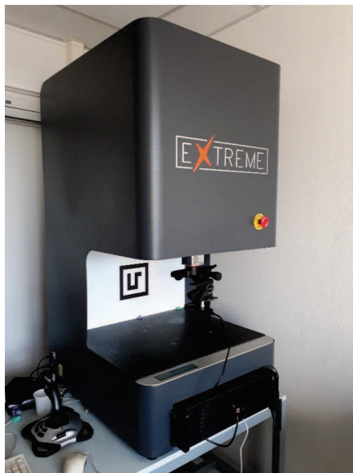
FIGURE 25 – Le plan d'étalonnage et sa configuration sur le CMM.
