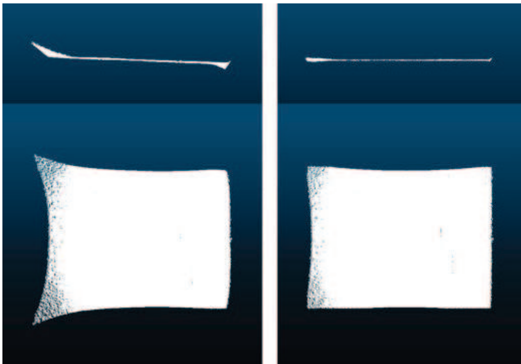
FIGURE 36 – Gauche : vue de face et de dessus d’un nuage de points (surface plane) avant correction. A droite, le même plan après correction en utilisant notre méthode.
