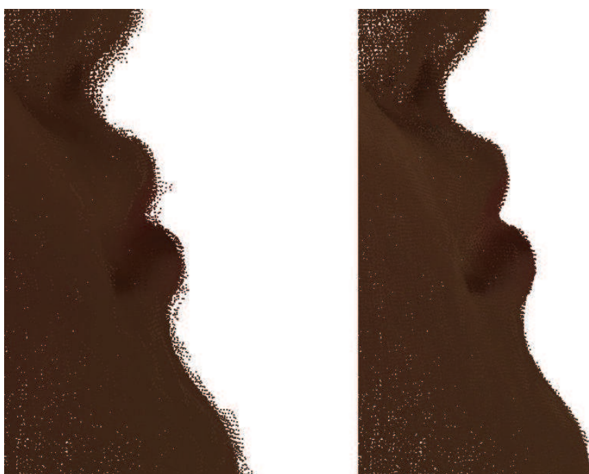
FIGURE 49 – Exemple de filtrage avec un minimum de 15 voisins sur un rayon de 1 mm sur le nuage final (recalé). A droite le nuage avant et à gauche le nuage après filtrage.
