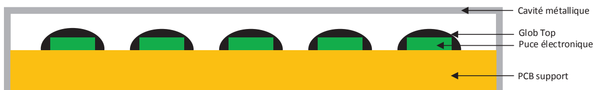
Figure III-17 : Concept d'encapsulation système + Glob Top
