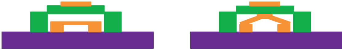
Figure II-8 : Vue de côté d'un RF-MEMS en état OFF à gauche, en état ON à droite
