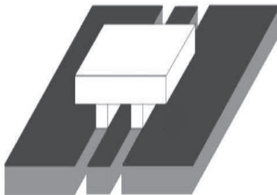
Figure II-4 : Schéma 3D d'un guide d'onde coplanaire avec un bloc de diélectrique [35]
