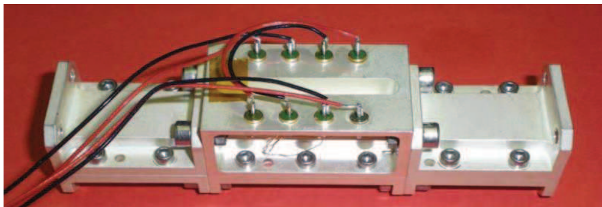
Figure II-15 : Photographie d'un déphaseur à ferrite en bande Ka de la société COMDEV [50]
