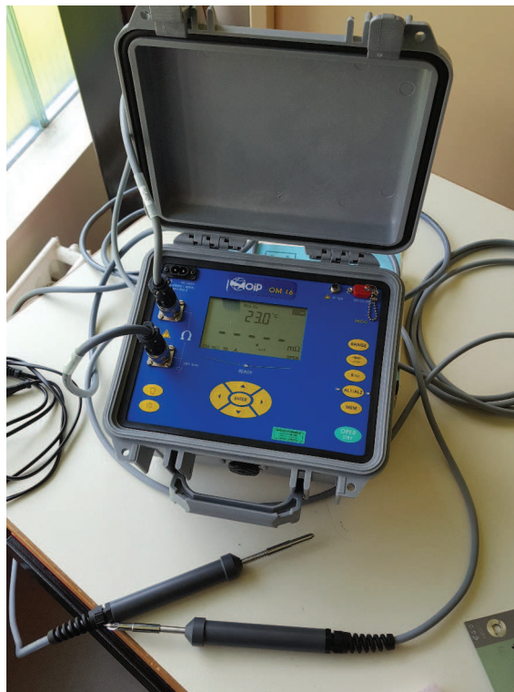
FIGURE III.3 – Photographie du micro-ohmmètre OM16
