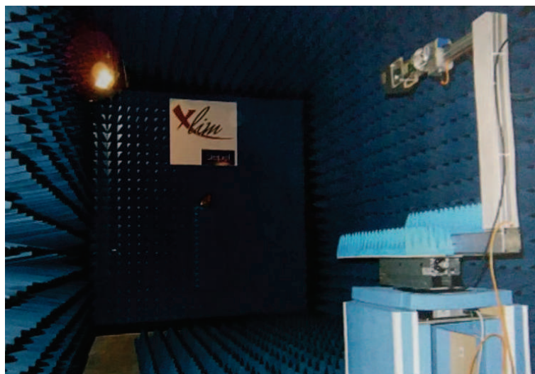
FIGURE 3.11 – Photo de la chambre anéchoïque du laboratoire XLIM
