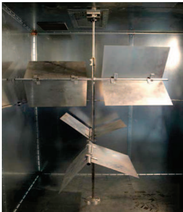
FIGURE 1.4 – Photographie du brasseur de modes de la CRBM du laboratoire XLIM
