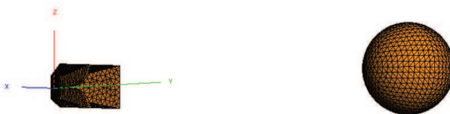
FIGURE 2.19 – Exemple de simulation FEKO montrant le modèle d'une antenne cornet double ridge et la sphère
