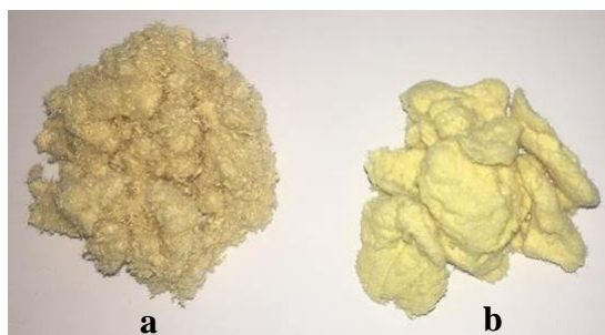
Figure 69: Fibres de pâte thermomécanique non modifiées; b: Fibres de pâte thermomécanique greffées avec le Thymol-Triazine
