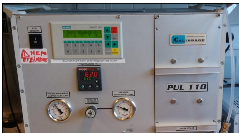
Figure III-33 - Générateur de vapeur (PULL 110)
