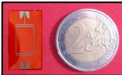
Figure A-2-structure fabriqué sur kapton
