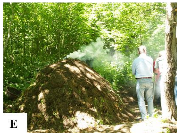
Figura 24. Alcune fasi della ricostruzione storica della carbonaia realizzata nel 2010 dal carbonaio Orlando su iniziativa del CAI di Sassuolo. A: costruzione della “ rocchetta ” e del camino centrale; B: posa dei primi pezzi; C: catasta di legna a forma di cupola completata; D: impermeabilizzazione o copertura della carbonaia; E: accensione della carbonaia. (Foto D. Maccaferri - gentilmente fornite dal Sig. Claudio Fregni).
