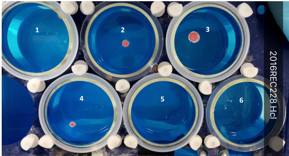
Figure 35 : Résultats du test de dissolution, phase acide 0,1 M HCl, d'échantillons de valproate de sodium gastro-résistants dosés à 200 mg, fabriqués en Inde, échantillonnés à Mombasa (Kenya) dans une pharmacie.
