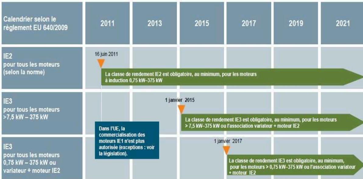
FIGURE 1.1 – Calendrier correspondant à la mise en place des différentes classes de rendements [4]
