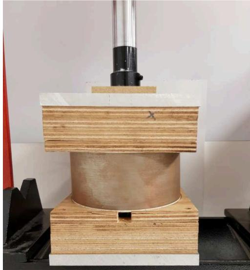
FIGURE 3.3 – Assemblage expérimental de la machine statique
