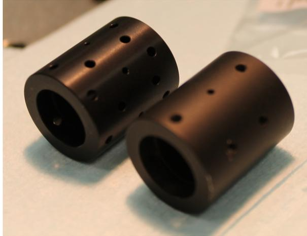
FIGURE 3.59 – Supports d'assemblage anodisés. Le support de droite correspond au support sans modification, utilisant la technique des fils. Celui de gauche correspond au support modifié.
