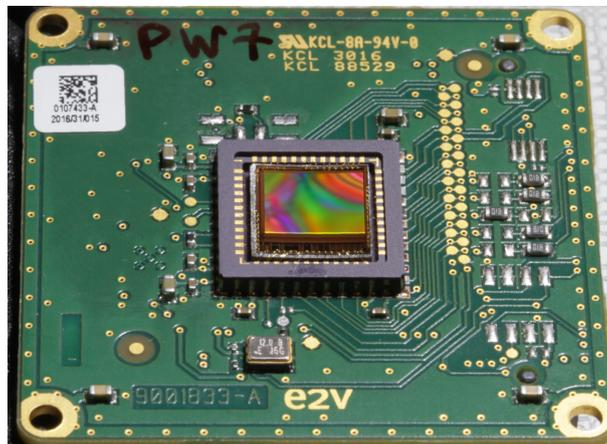
FIGURE 3.54 – Puce courbe réalisé au CEA sur sa carte électronique e2v.
