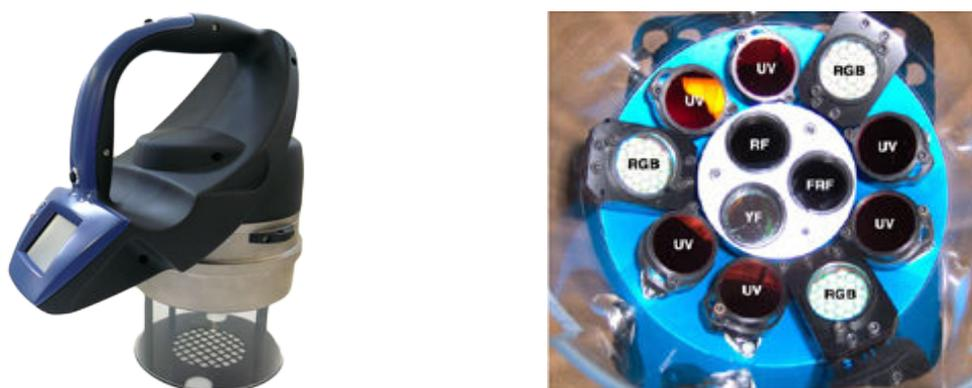
**Figure 2-9** : Equipement portable pour la mesure de la fluorescence des phytométabolites (Multiplex, FORCE-A®, Orsay)
