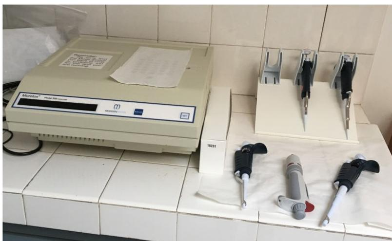
**Figure 2-6** : Luminomètre thermostaté Microtox 500
