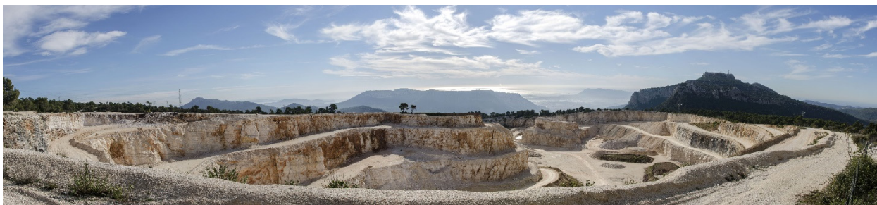
Fig. 2.41 : Illustration de la carrière de Fiéraqet directement en amont des sources de Dardennes. Dans cette carrière aucun indice de réseaux karstiques bien développés n'est visible. L'infiltration y est rapide mais se fait de manière diffuse dans un maillage tectonique N40-N140 resserré. Les réseaux de subsurface ne sont pas structurés (photo : C. Baudement).
