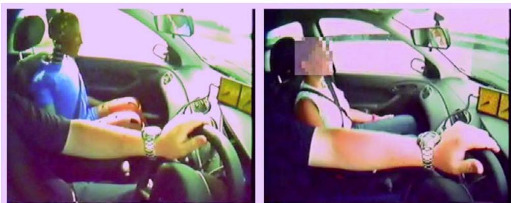
FIGURE I-34 : PROJET PRISM - COMPARAISON DU COMPORTEMENT DYNAMIQUE ENTRE UN MANNEQUIN ET UN HUMAIN
