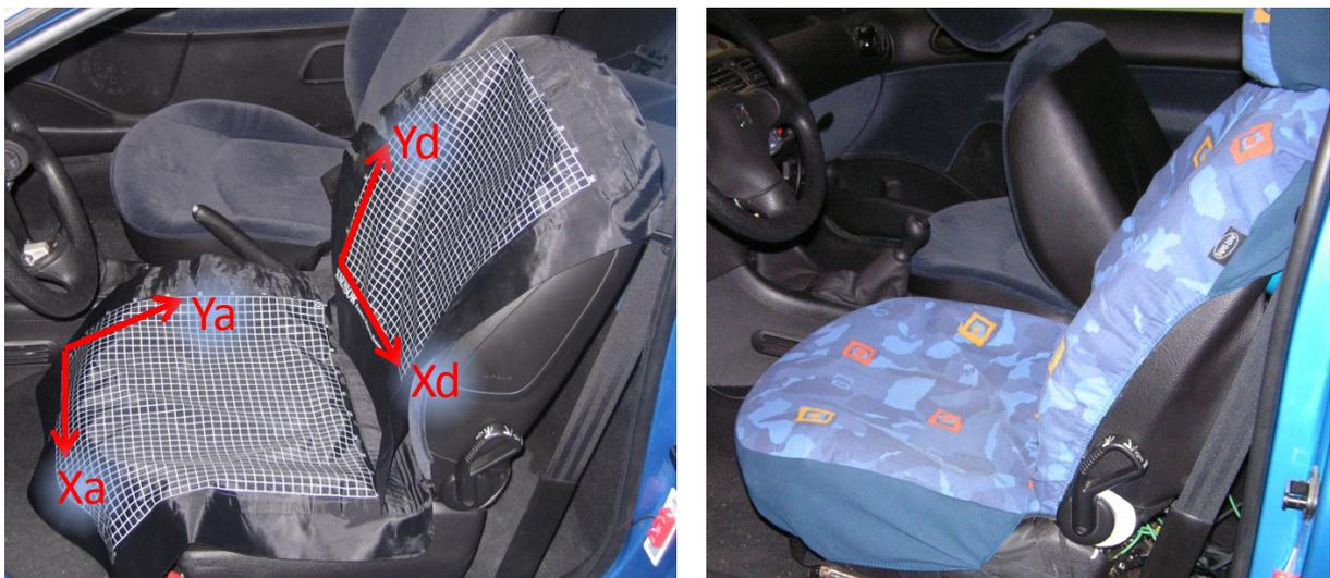
FIGURE II-22 : RÉPARTITION DES PRESSIONS SUR LE SIÈGE
