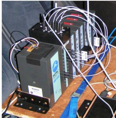
*FIGURE II-33 : SYSTÈME D'ACQUISITION DE DONNÉES PHYSIologiques BIOPAC MP150*
