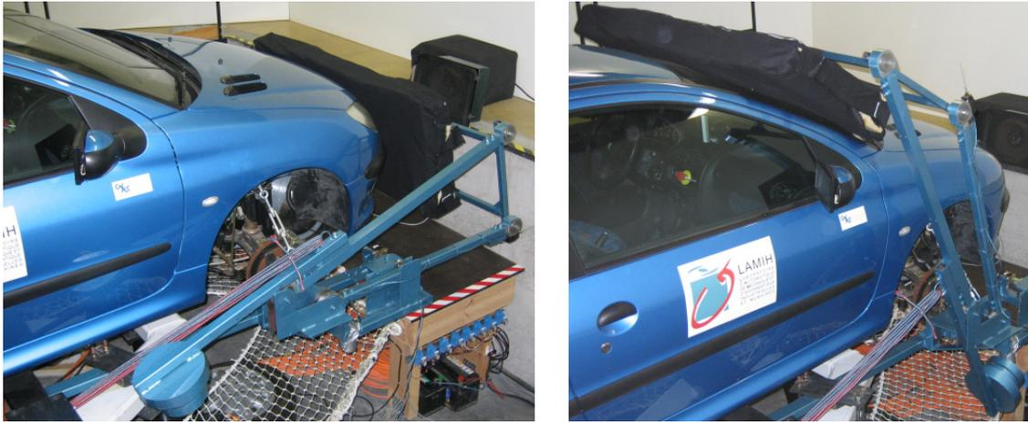
*FIGURE II-7 : SIMULATEUR SHERPA DYNAMIQUE – IMPACTEUR EMBARQUÉ*
