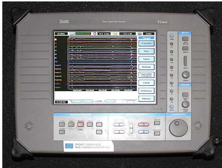
*FIGURE II-35 : OSCILLOSCOPE NUMÉRIQUE « NICOLET VISION »*
