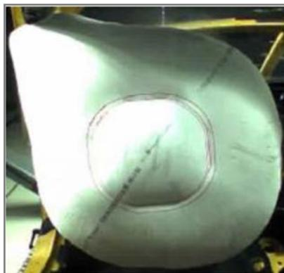
*FIGURE I-23 : AIRBAG CONDUCTEUR ASYMÉTRIQUE - TRW*
