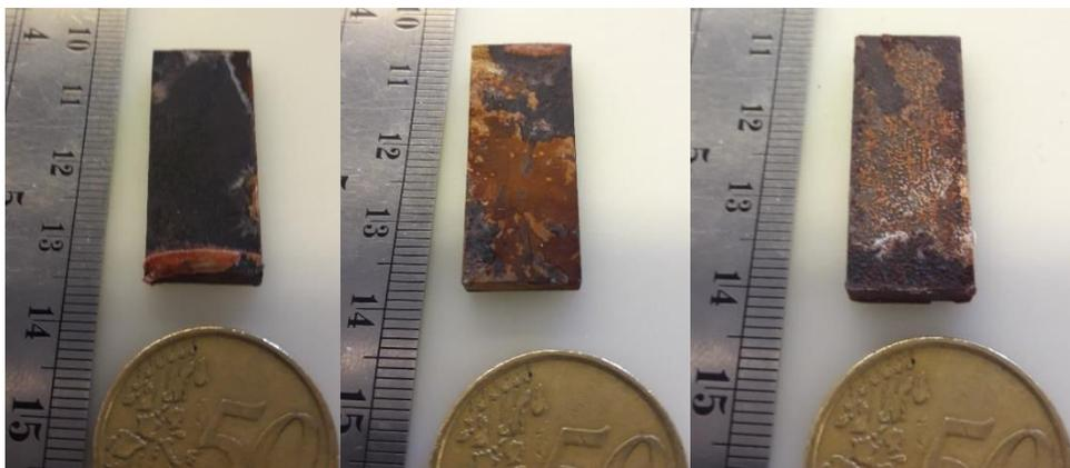
Figure III-51 : Coupon d'acier P265GH après 4 jours d'immersion dans l'acide sébacique. De gauche à droite (a) : 146 °C. (b) : 156 °C. (c) : 166 °C
