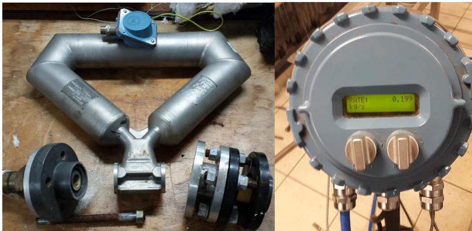
Figure IV-15 : Débitmètre massique à effet Coriolis. Gauche (a) : Corps du débitmètre. Droite (b) : Corps de l’afficheur
