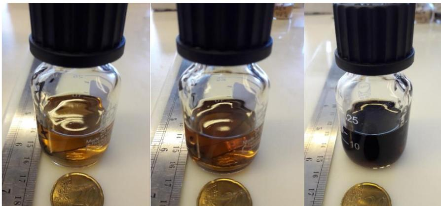
Figure A-28 : Acide sébacique Altichem + inox 316L vieilli après 16 jours à l'étuve. De gauche à droite (a) : 146 °C. (b) : 156 °C. (c) : 166 °C
