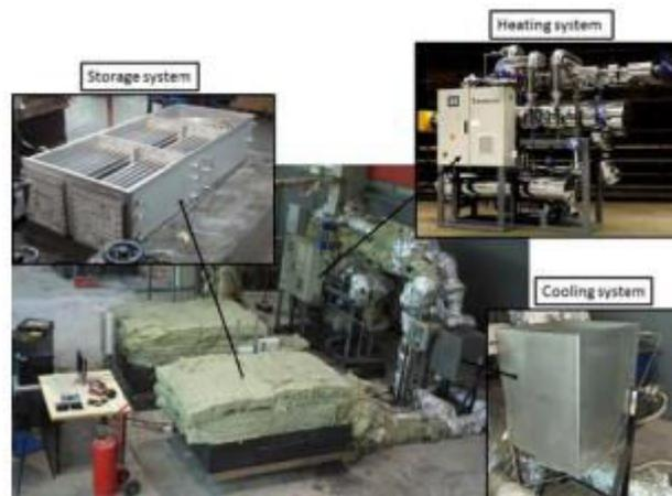
Figure I-15 : Vue d'ensemble du système expérimental de stockage [Gasia et al., 2016]
