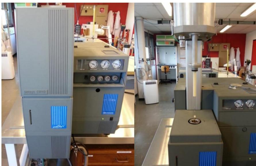
Figure II-14 : Vue de face du thermogravimètre Setsys Cryostat
