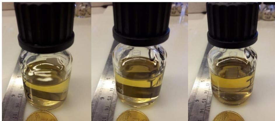
Figure III-31 : Acide sébacique Arkema + inox 316L vieilli après 4 jours à l'étuve. De gauche à droite (a) : 146 °C. (b) : 156 °C. (c) : 166 °C
