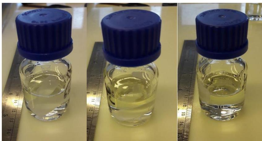
Figure III-12 : Acide stéarique industriel vieilli après 28 jours à l'étuve. De gauche à droite (a) : 65 °C. (b) : 75 °C. (c) : 85 °C
