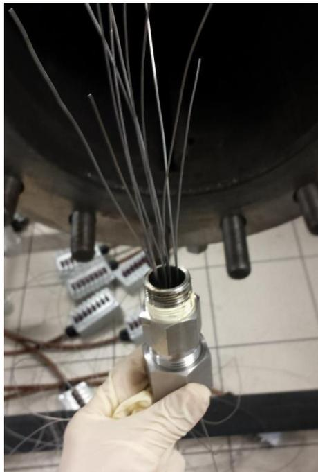
Figure IV-24 : Passage étanche pour thermocouples
