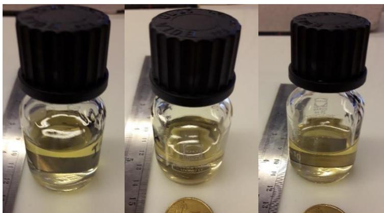
Figure A-26 : Acide sébacique Altichem + inox 316L vieilli après 1 jour à l'étuve. De gauche à droite (a) : 146 °C. (b) : 156 °C. (c) : 166 °C
