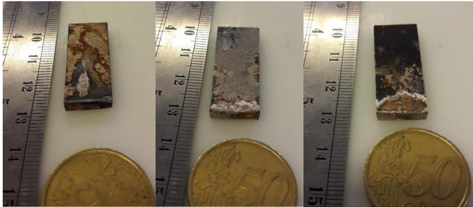
Figure III-50 : Coupon d'acier P265GH après 1 jour d'immersion dans l'acide sébacique. De gauche à droite (a) : 146 °C. (b) : 156 °C. (c) : 166 °C
