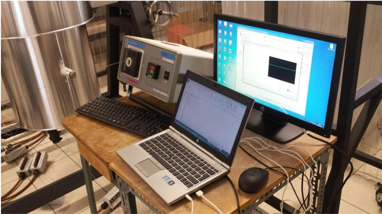
Figure IV-23 : Etalonnage des thermocouples
