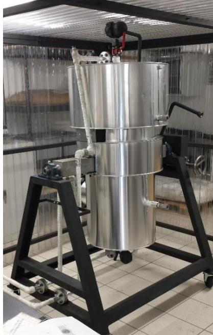
Figure IV-13 : Cuve de stockage après calorifugeage
