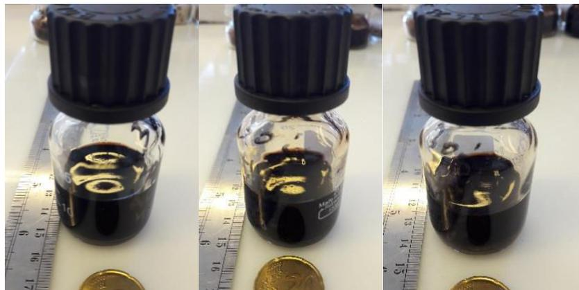
Figure A-21 : Acide sébacique Altichem + acier P265GH vieilli après 30 jours à l'étuve. De gauche à droite (a) : 146 °C. (b) : 156 °C. (c) : 166 °C
