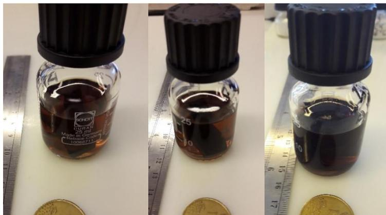
Figure III-43 : Acide sébacique Arkema + acier P265GH vieilli après 1 jour à l'étuve. De gauche à droite (a) : 146 °C. (b) : 156 °C. (c) : 166 °C
