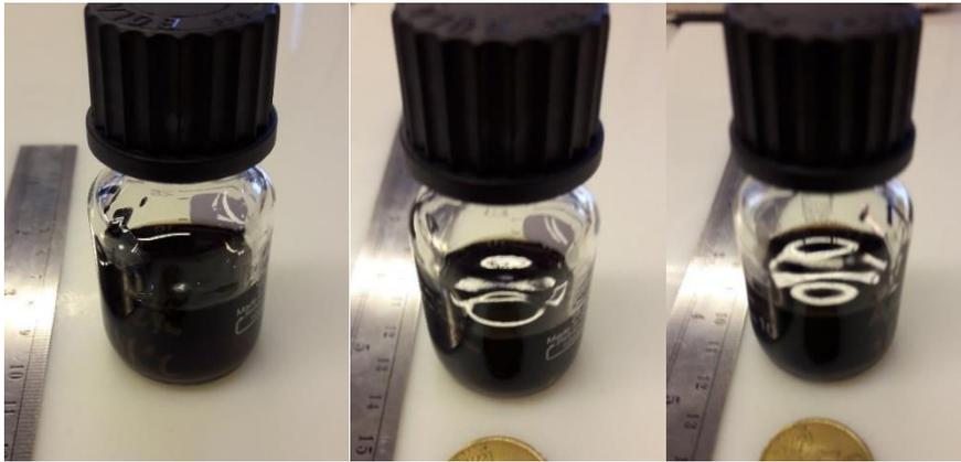
Figure A-19 : Acide sébacique Altichem + acier P265GH vieilli après 1 jour à l'étuve. De gauche à droite (a) : 146 °C. (b) : 156 °C. (c) : 166 °C
