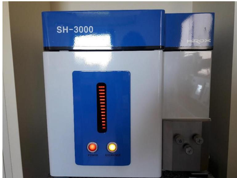
Figure III-2919 : Microscope électronique à Balayage (MEB)
