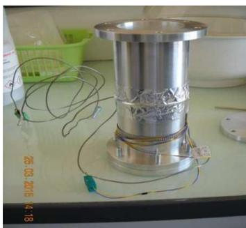
Figure II-10 : Vue d'une capsule en aluminium pour l'étude des MCP dans le calorimètre XL [Roget, 2012]
