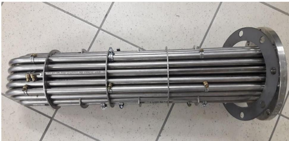
Figure IV-49 : Partie tubulaire de l'échangeur
