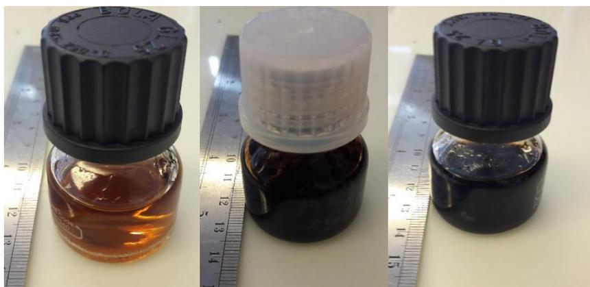
Figure III-24 : Acide sébacique Arkema vieilli après 62 jours à l'étuve. De gauche à droite (a) : 146 °C. (b) : 156 °C. (c) : 166 °C
