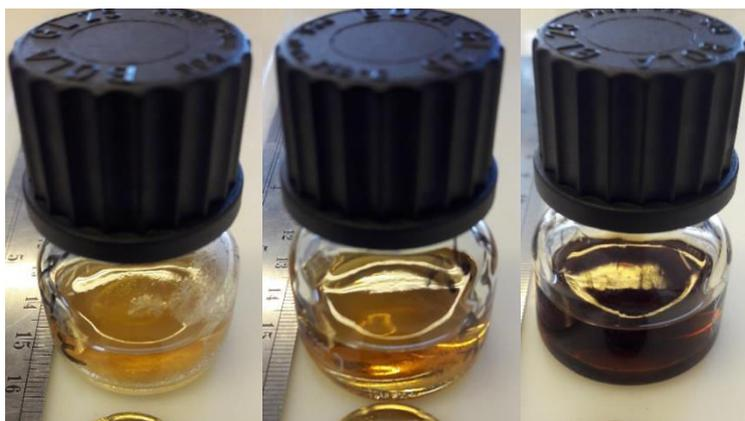
Figure A-22 : Acide sébacique Altichem vieilli après 16 jours à l'étuve. De gauche à droite (a) : 146 °C. (b) : 156 °C. (c) : 166 °C
