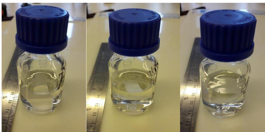
Figure III-11 : Acide stéarique industriel vieilli après 7 jours à l'étuve. De gauche à droite (a) : 65 °C. (b) : 75 °C. (c) : 85 °C
