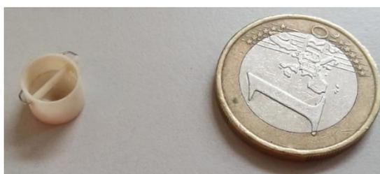
Figure II-16 : Nacelle en alumine
