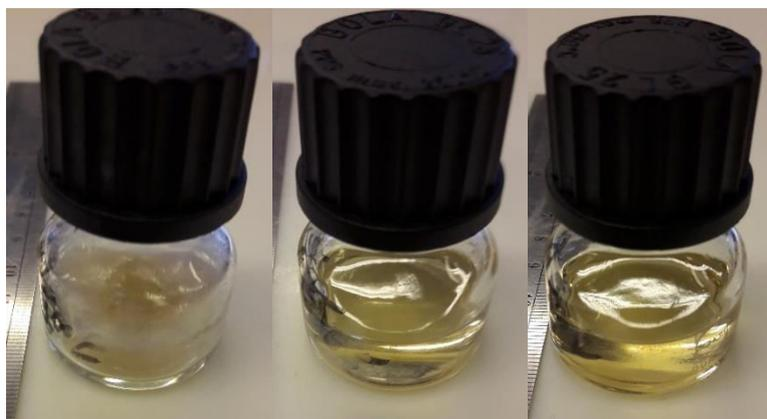
Figure A-20 : Acide sébacique Altichem vieilli après 1 jour à l'étuve. De gauche à droite (a) : 146 °C. (b) : 156 °C. (c) : 166 °C
