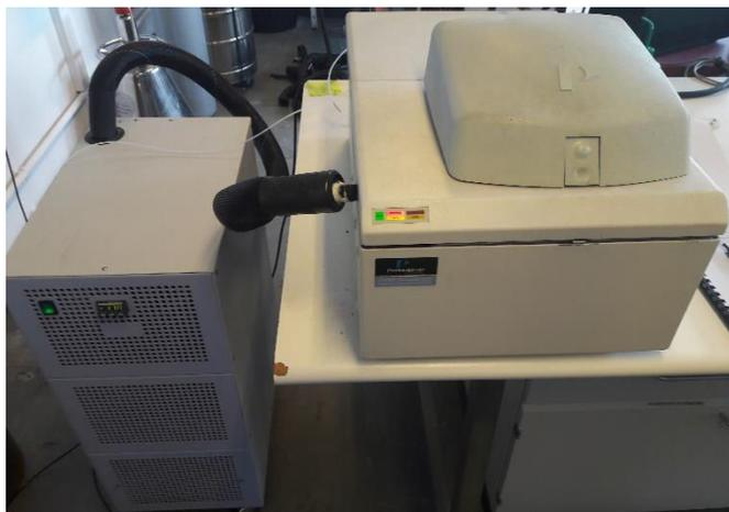
Figure II-7 : Vue de face du calorimètre Pyris Diamond DSC de Perkin-Elmer
