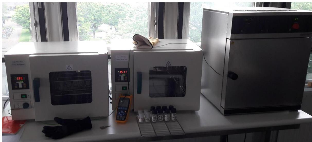
Figure III-5 : Etuves maintenues à trois niveaux de température
