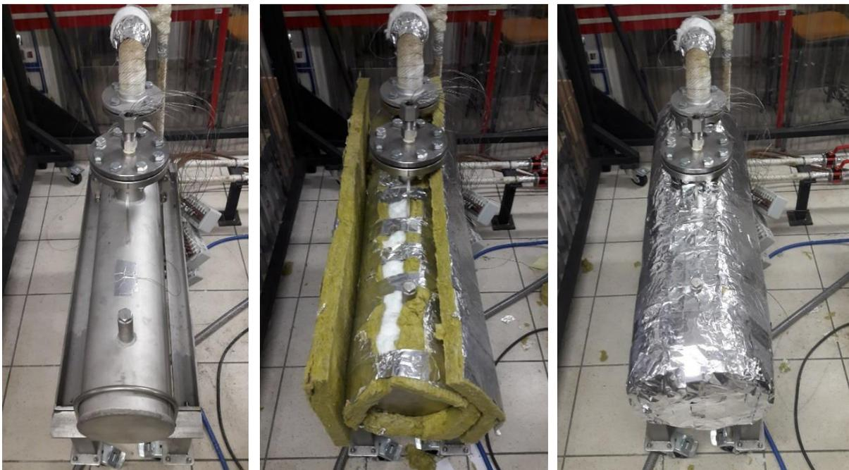
Figure IV-14 : Mise en place du calorifugeage de l'échangeur tubulaire
