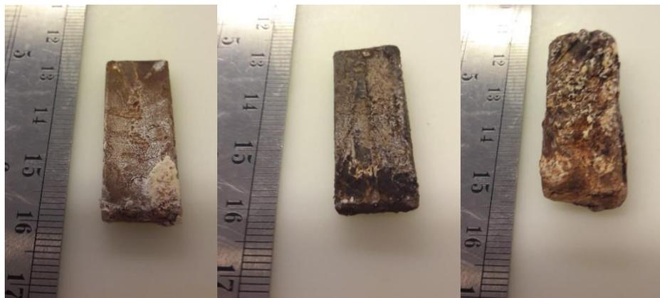
Figure III-53 : Coupon d'acier P265GH après 62 jours d'immersion dans l'acide sébacique. De gauche à droite (a) : 146 °C. (b) : 156 °C. (c) : 166 °C
