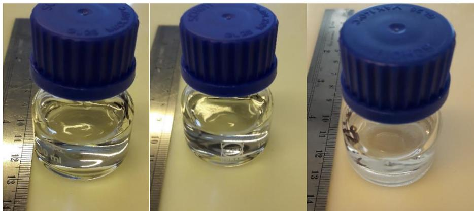
Figure III-6 : Acide stéarique industriel vieilli après 7 jours à l'étuve. De gauche à droite (a) : 65 °C. (b) : 75 °C. (c) : 85 °C
