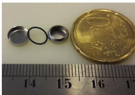
Figure II-8 : Cellule hermétique Pyris Diamond DSC de 60  $\mu\text{L}$
