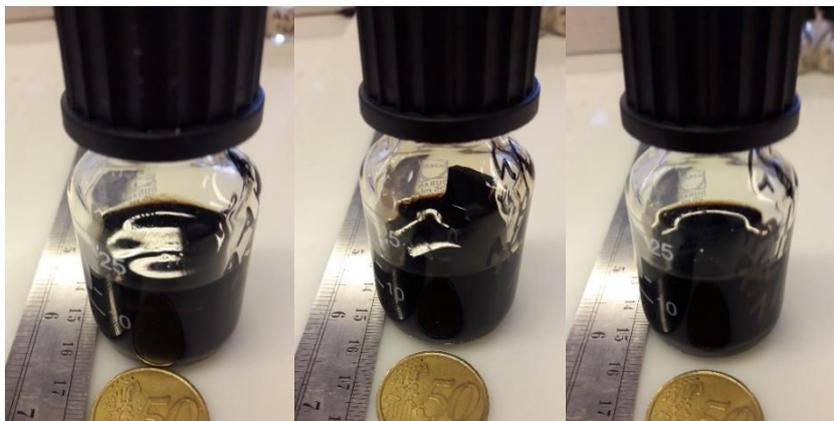
Figure A-20 : Acide sébacique Altichem + acier P265GH vieilli après 4 jours à l'étuve. De gauche à droite (a) : 146 °C. (b) : 156 °C. (c) : 166 °C
