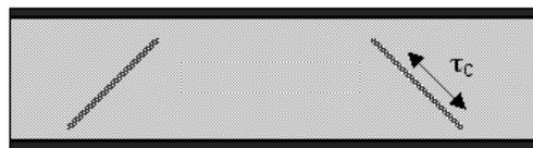
Figure 7 : Cisaillement de l'âme et schématisation de la rupture sous chargement en flexion 4 points (Allen, 1969a)
