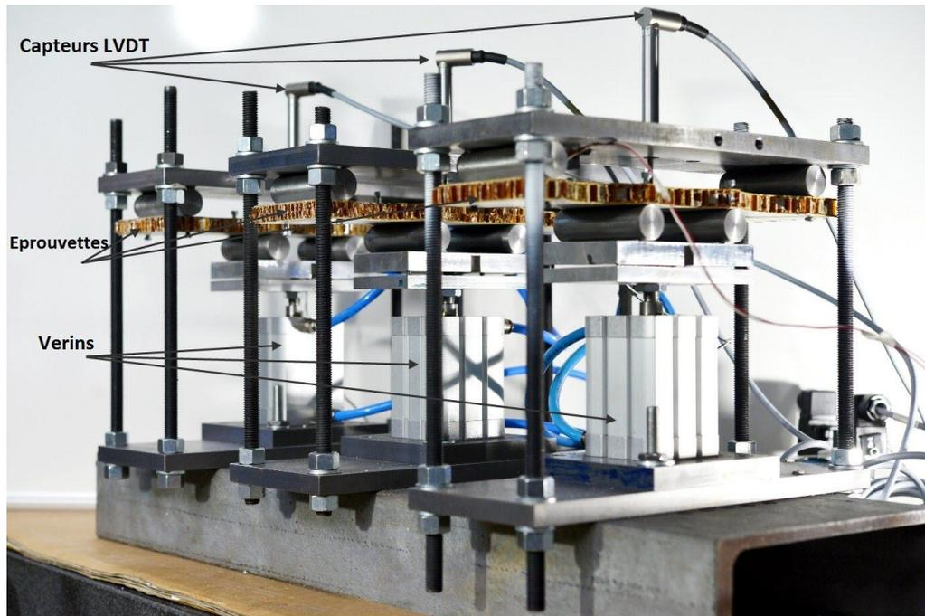
Figure 103 : Montage de flexion en fatigue
