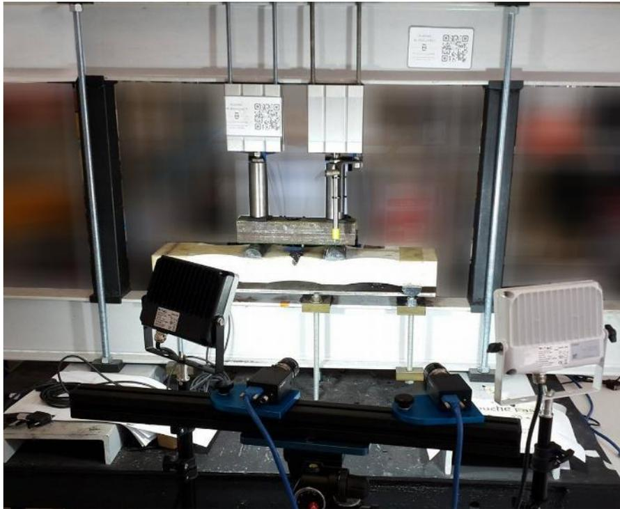
Figure 56 : Montage d'essai et dispositif de corrélation d'images
