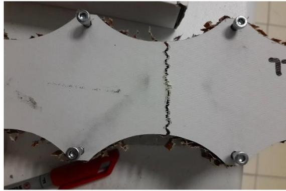
Figure 110 : Rupture des peaux en compression du sandwich à base de Nid d'abeilles
