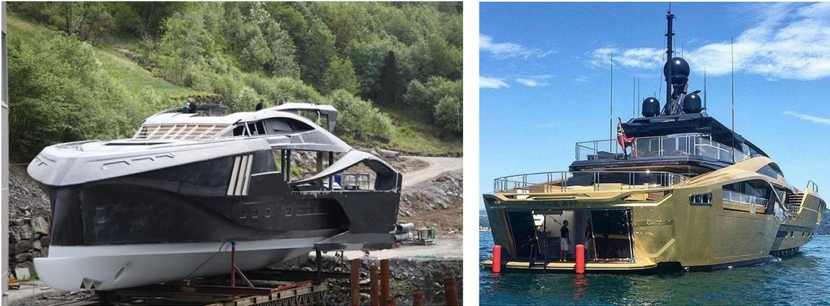
Figure 1 : Palmer Johnson 48M SuperSport fabriqué en sandwich carbone-vinylester.
