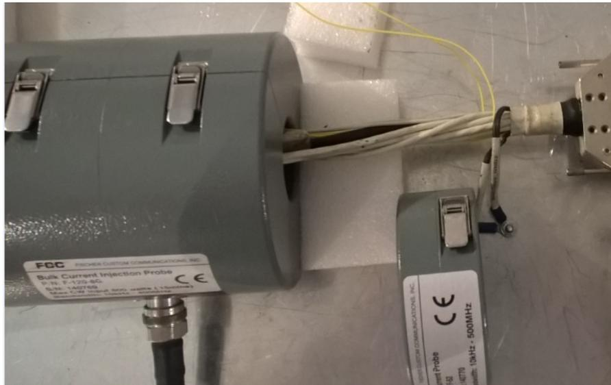
Figure 4.24 – Pince de mesure en dehors du toron
