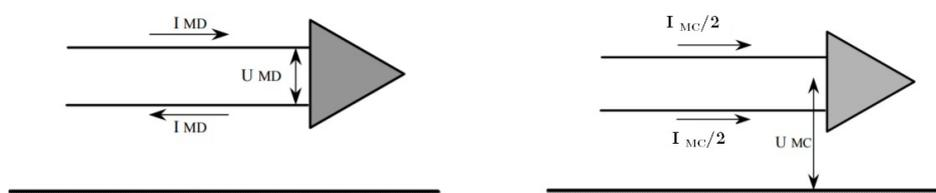
Figure 3.1 – Illustration des courants et tensions de mode commun et mode différentiel
