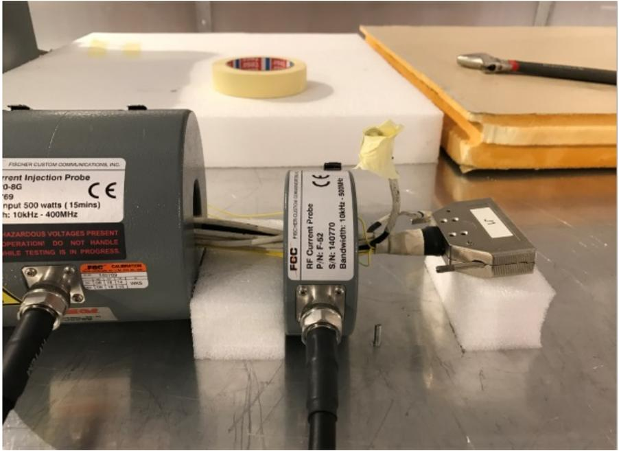
Figure 4.22 – Configuration avec blindage et EST déconnectés
