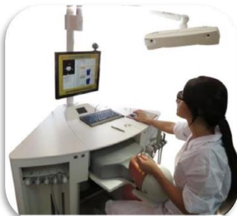
**Figure 14: Unité de formation avec Dentsim® (camera de repérage en haut à droite.)**
