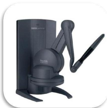
**Figure 19: Le dispositif haptique Geomagic Touch X (anciennement phantom desktop® de chez sensible) utilisé pour le Virteasy®**
