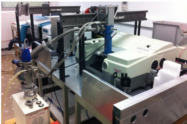
Figure I.1.9 : spectromètre Nicolet 5700 FT-IR présent au laboratoire CRM2, disposant d'un cryostat fermé amovible.
