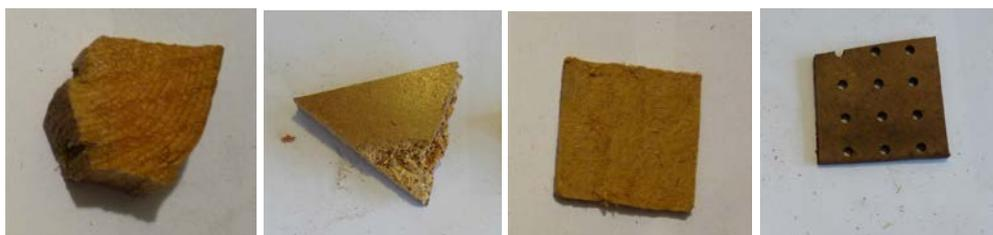
FIGURE 1.1 – Exemple de déchets de bois : de gauche à droite, bois pur, panneau de particules, MDF/HDF brut, fibre dure brut.
