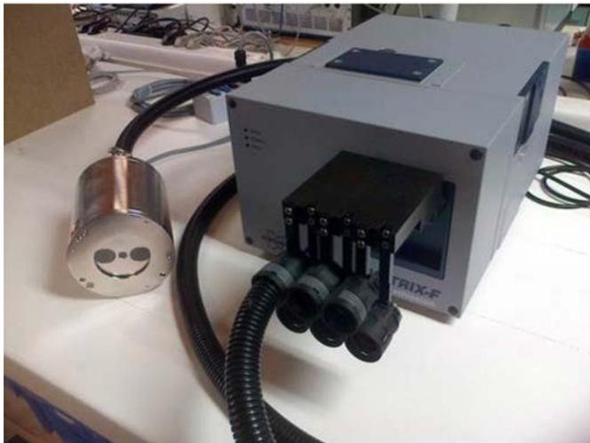
FIGURE 1.9 – Spectromètre Matrix-F Brüker utilisé pour l’acquisition des spectres par le Crittbois.
