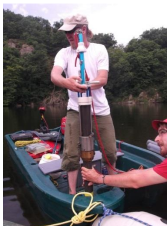
Figure 29 : Carotte sédimentaire prélevée à l'aire d'un carottier UWITECH sur la retenue de Champsanglard. Personnes présentes : Pr. Emmanuel Chapron, Dr. Léo Chassiot.
