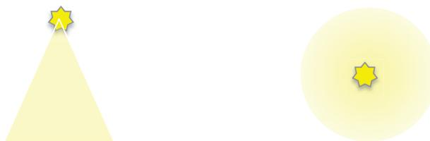
FIGURE 1.12 – Une source de type spot et une source omnidirectionnelle.
