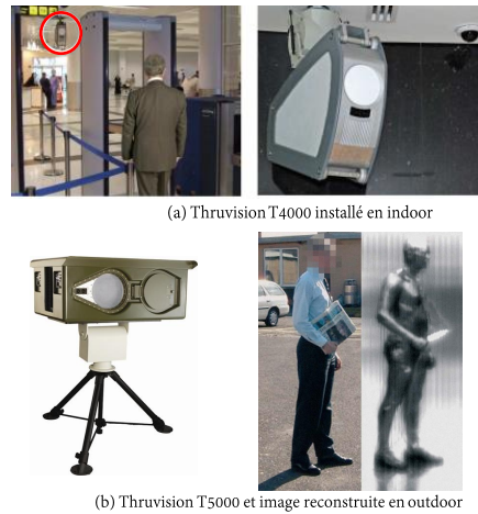
FIGURE 1.46 – Système d'imagerie Thruvision [133].
