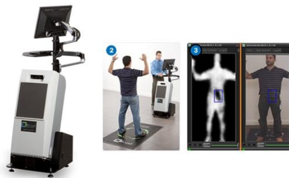
FIGURE 1.45 – Système d'imagerie passif Brijot GEN2 System [130].
