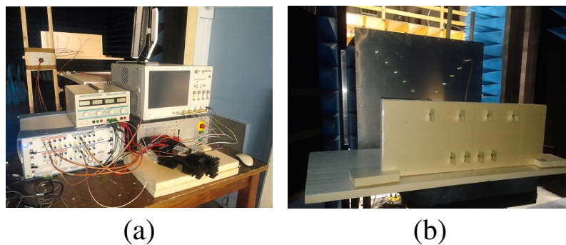
FIGURE 3.18 – Bancs de mesure Radar MIMO. (a) Architecture conventionnelle de Radar MIMO avec 4 antennes et 4 voies RF. (b) MIMO à voie RF unique en transmission. Une seule voie est utilisée pour alimenter les 4 antennes Tx.
