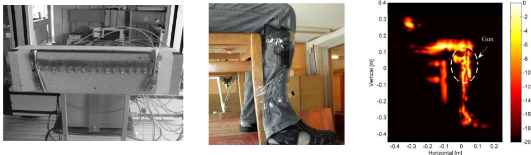
FIGURE 1.50 – Prototype de système de détection d'arme développé à l'Université de Delft [139].
