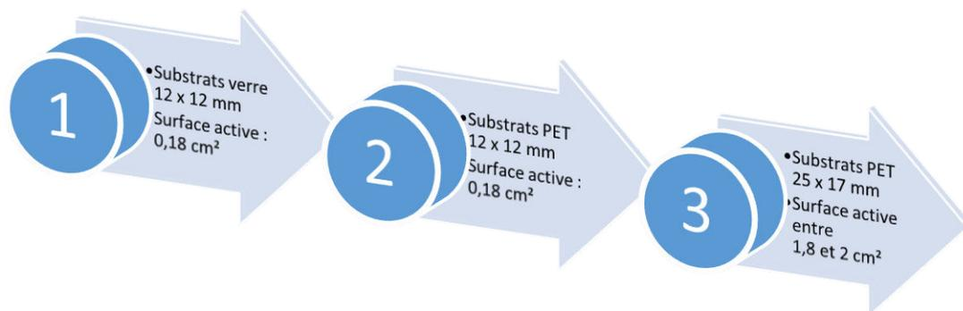
*Figure 49 : Les différentes phases de développement de cellules : Phase 1 – substrat verre (1<sup>ère</sup> et 2<sup>e</sup> année), phase 2 – substrat plastique (1<sup>ère</sup> et 2<sup>e</sup> année), phase 3 – passage sur des tailles de substrat plus grandes (2<sup>e</sup> et 3<sup>e</sup> année)*
