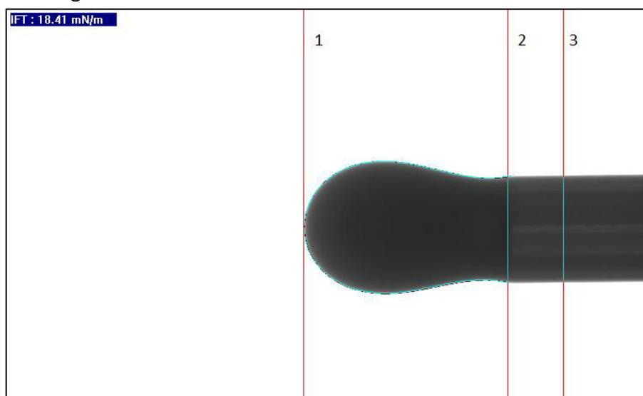
Figure 86 : Mesure de la tension de surface d'une encre d'argent imprimable
