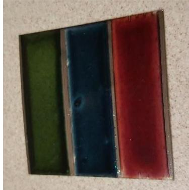
*Figure 73 : Module polychrome non fonctionnel, les couleurs différentes sont dues au polymère donneur de la couche active*
