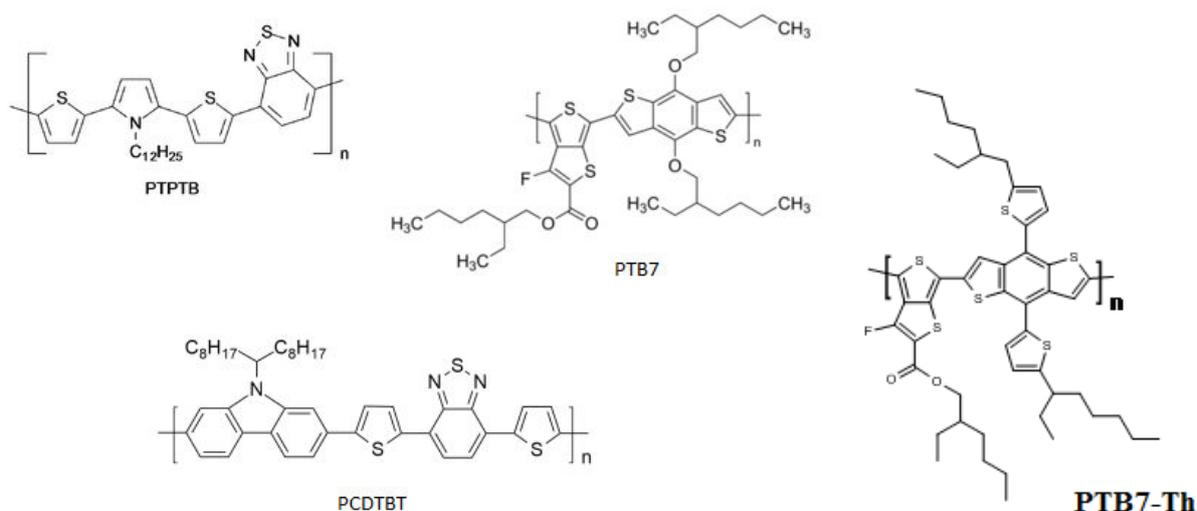
Figure 14 : Quelques polymères à faible bande interdite utilisés dans l'élaboration des cellules solaires organiques
