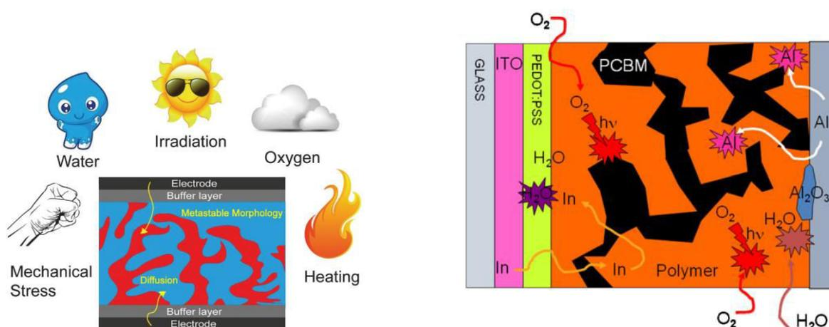
Figure 28 : (a) Principaux facteurs impactant les performances et la stabilité des cellules OPV<sup>81</sup>, (b) les différents mécanismes de dégradation intervenant dans une cellule solaire organique à hétérojonction en volume<sup>82</sup>
