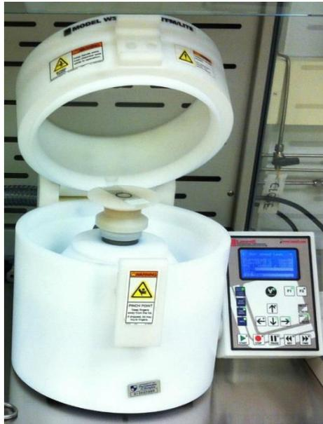
Figure 51 : Modèle de tournette utilisé pour la fabrication de cellules solaires organiques
