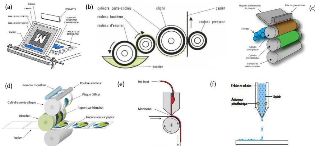
Figure 47 : Techniques d'impression : (a) sérigraphie<sup>177</sup>, (b) flexographie<sup>178</sup>, (c) héliographie<sup>179</sup>, (d) offset<sup>180</sup>, (e) slot-die<sup>181</sup>, (f) impression jet d'encre<sup>182</sup>
