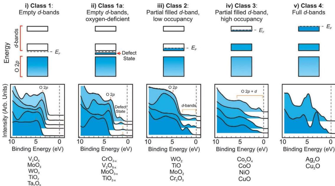
Figure 38 : Schéma des diagrammes de bandes et des spectres de photoémission des bandes de valence de différents oxydes de transition classés selon le taux d'occupation de la bande  $d^{113}$
