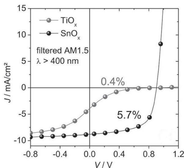
Figure 41 : Courbes  $J(V)$  des cellules inversées à base de P3HT : PCBM avec  $\text{TiO}_x$  (clair) et  $\text{SnO}_x$  (foncé) avec filtre bloquant les UV<sup>48</sup>
