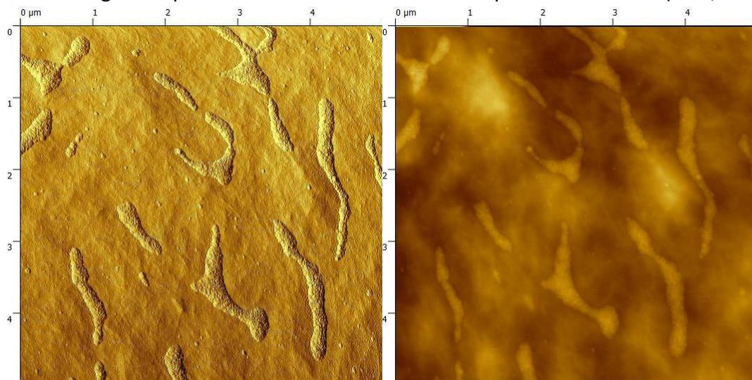
Figure 67 : Cartographies AFM de la dispersion des nanoparticules de  $WO_3$  diluée à 5% de la solution initiale sur la couche active P3HT : PCBM
