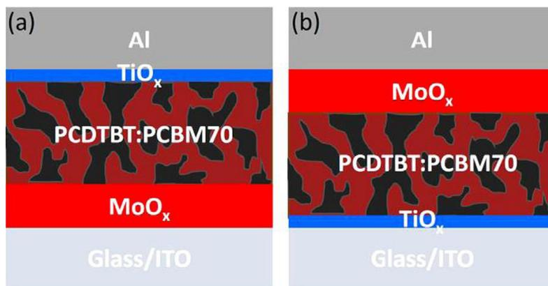
Figure 32 : Structure standard (a) et structure inverse (b) avec pour interfaces le  $TiO_x$  et le  $MoO_x$
