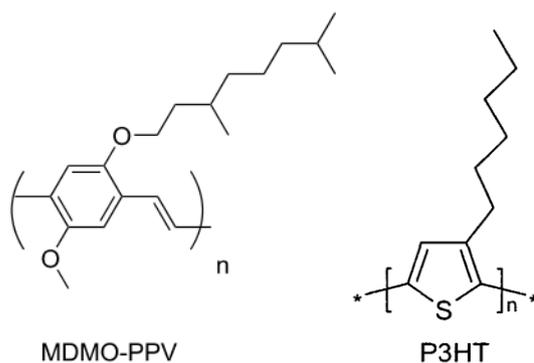
Figure 12 : Structure chimique de polymères conjugués couramment employés dans la fabrication de cellules solaires organiques
