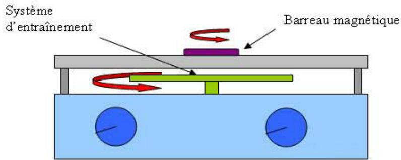
Figure 60 : Représentation schématique de l'agitation magnétique avec barreau aimanté<sup>242</sup>
