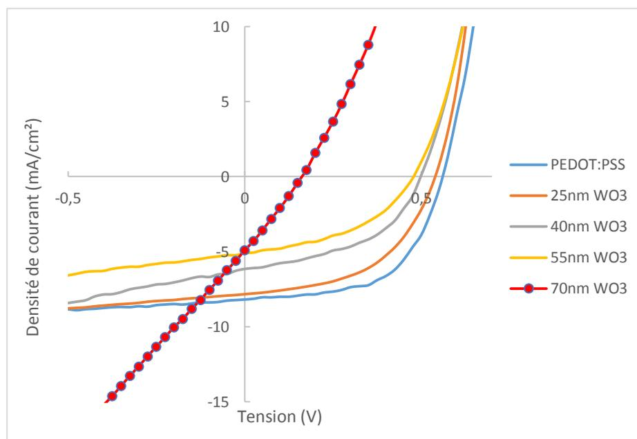
Figure 56 : Courbes J(V) des cellules solaires obtenues en fonction de l'épaisseur de WO<sub>3</sub> et comparées avec la référence.
