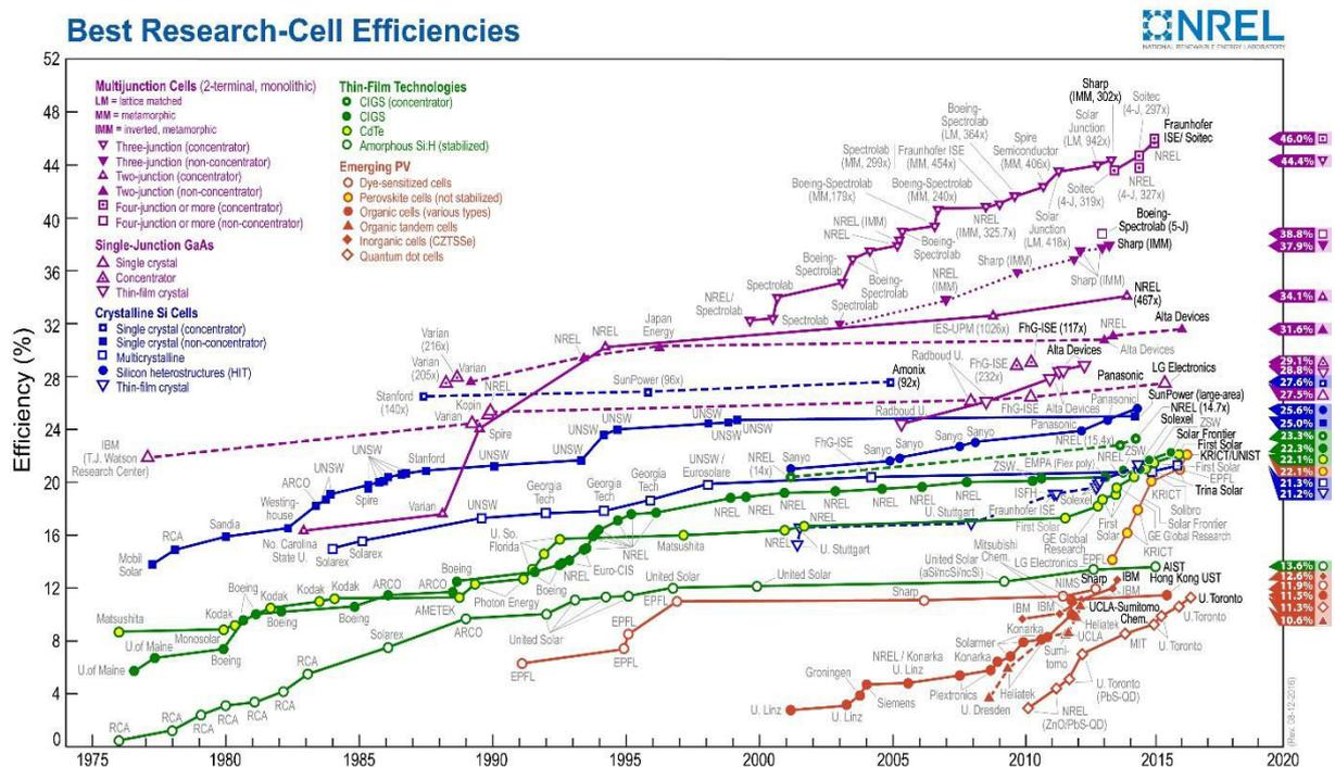
Figure 6 : Tableau comparatif des différentes technologies de cellules solaires publié par l'organisme NREL<sup>19</sup>
