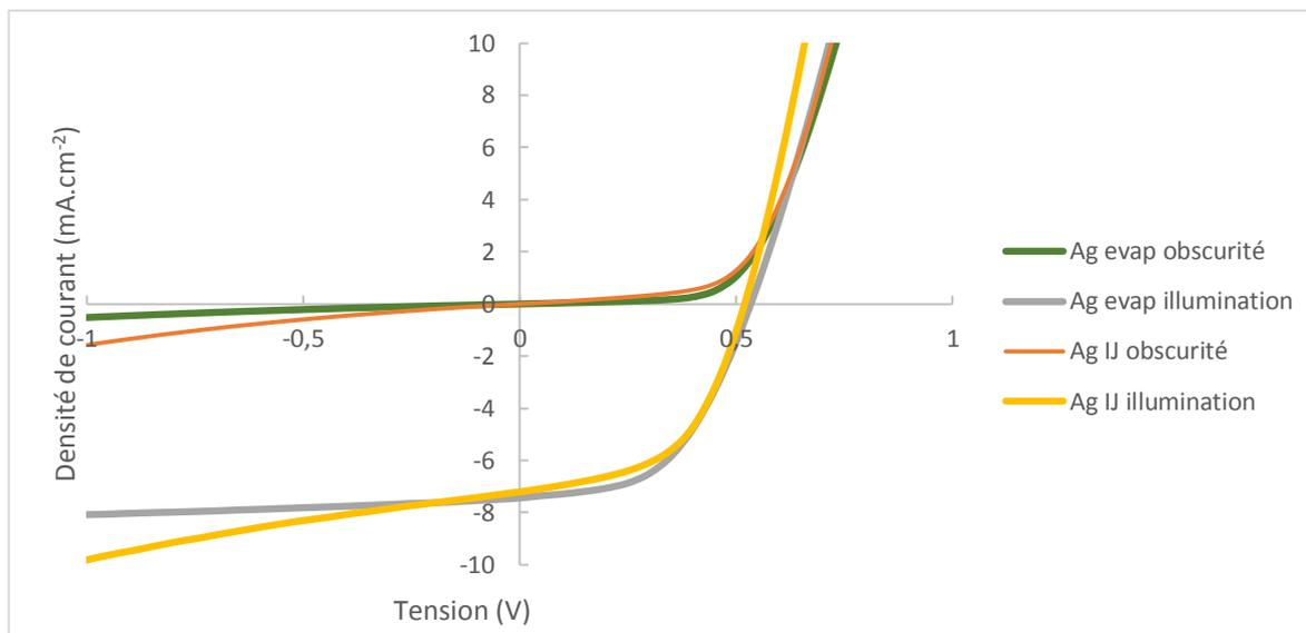
Figure 99 : Courbes  $J(V)$  à l'obscurité et sous illumination des cellules solaires en fonction du type de dépôt d'argent
