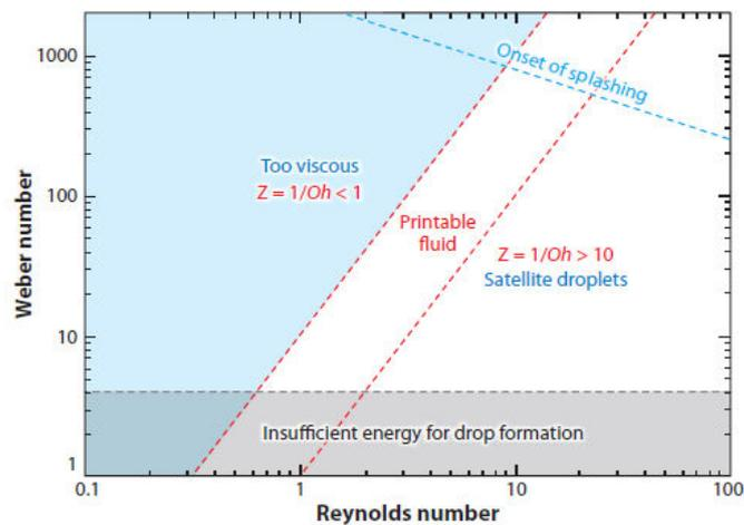
Figure 92 : Différentes propriétés d'une encre et régime d'imprimabilité selon les nombres de Weber et Reynolds<sup>38</sup>
