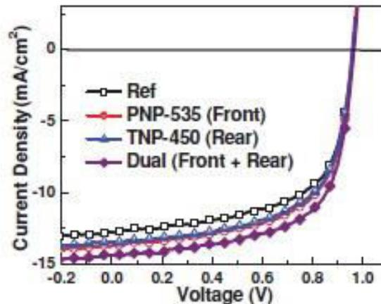
Figure 42 : Courbes  $J(V)$  de cellules à base de PIDTT-DFBT/ $PC_{71}BM$  avec et sans nanoparticules d'argent incorporées dans les interfaces
