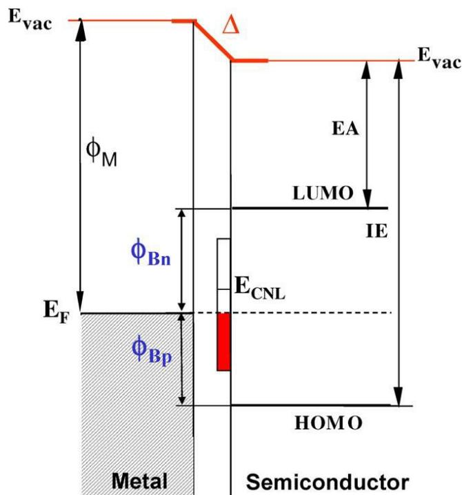
Figure 30 : Schéma de la structure électronique à l'interface métal/semi-conducteur (organique) avec les différents niveaux d'énergie pour chaque matériau, le niveau du vide ( $E_{vac}$ ), le niveau de Fermi ( $E_F$ ), le travail de sortie du métal ( $\Phi_M$ ), l'affinité électronique (EA), l'énergie d'ionisation (IE) du polymère et  $E_{CNL}$  le niveau de neutralité de charge
