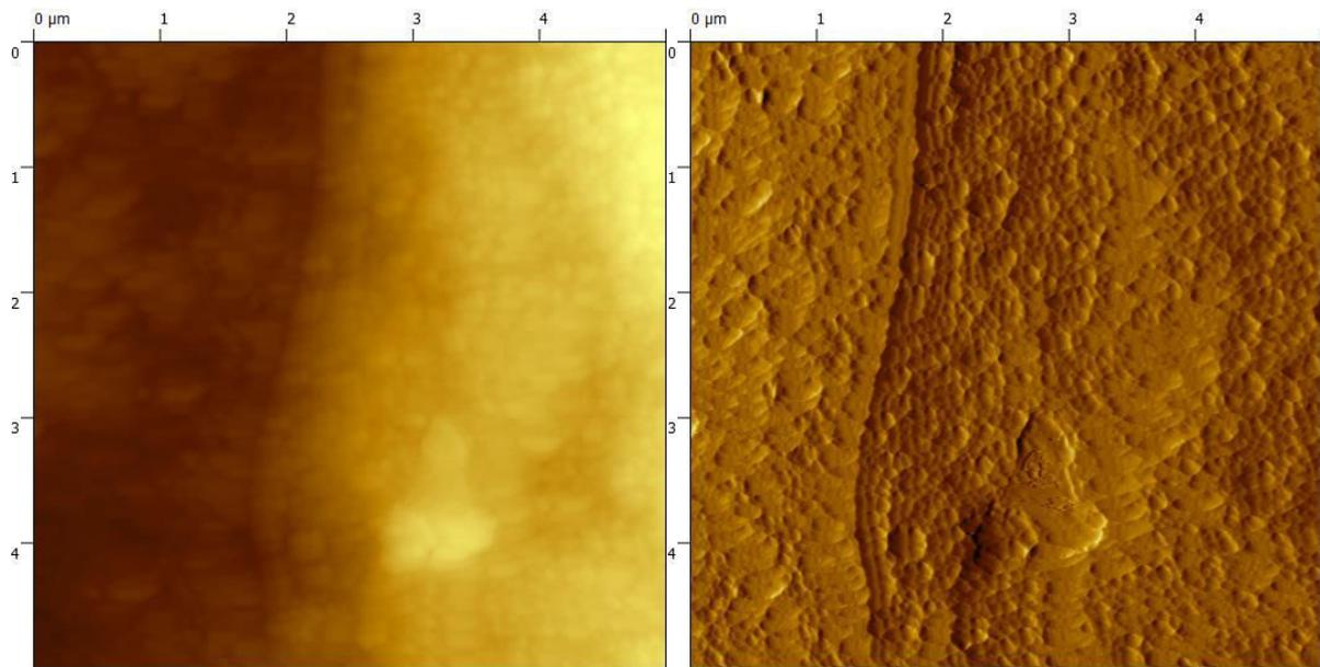
Figure 64 : Images AFM ( $5 \times 5 \mu\text{m}$ ) des couches de nanoparticules de  $\text{WO}_3$  après agitation ultrasonique (à gauche image topographique, à droite l'amplitude)
