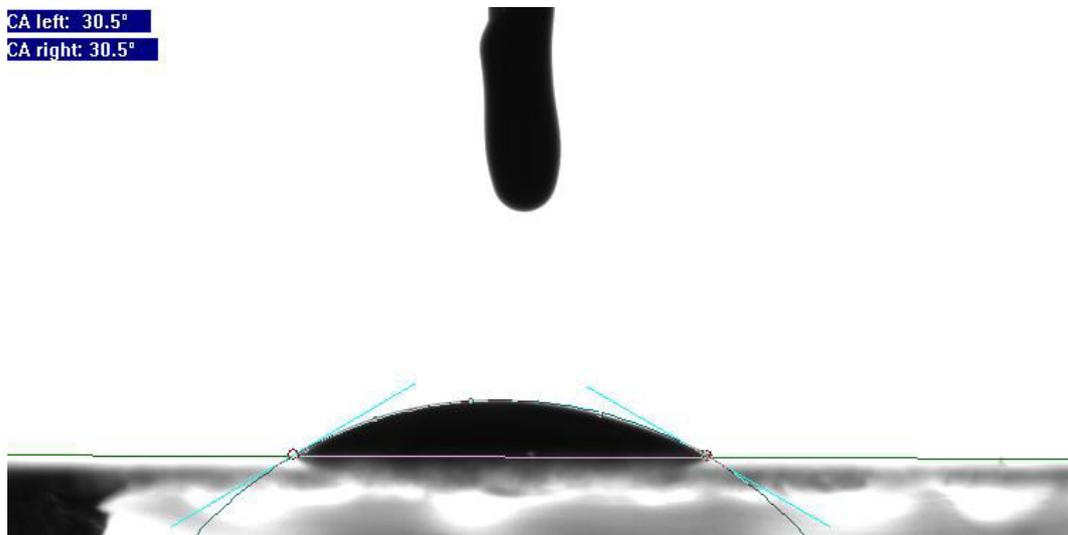
Figure 88 : Image de la mesure d'angle de contact d'une encre d'argent sur du PEDOT : PSS
