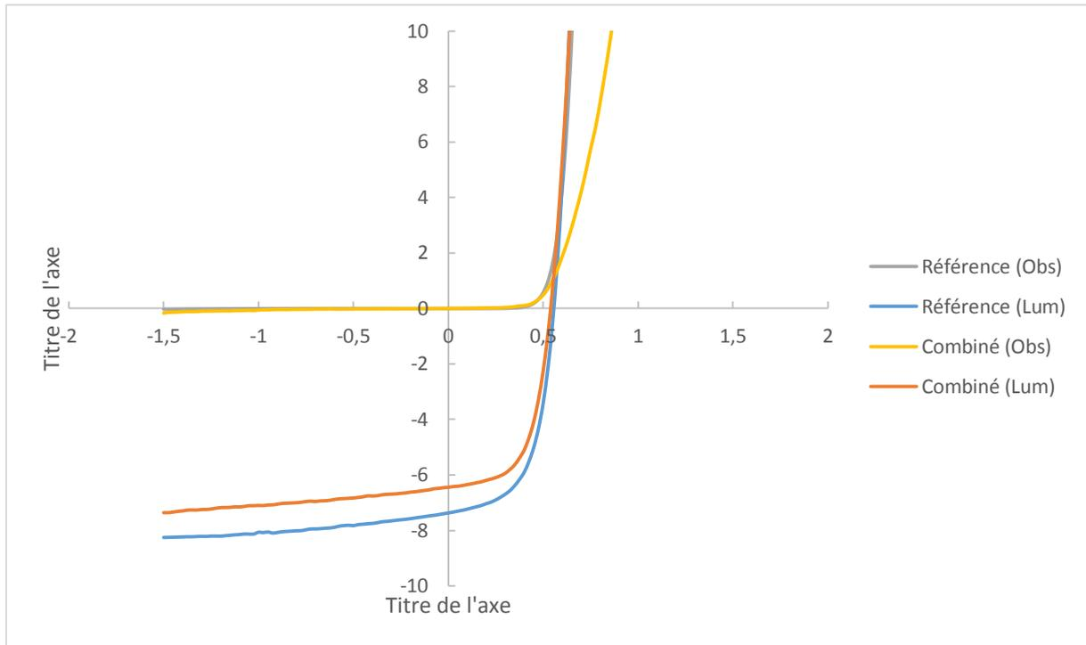
Figure 72 : Courbes J(V) des cellules solaires de référence (ZnO et PEDOT :PSS) et avec la combinaison des nouvelles interfaces sur substrat plastique à l'obscurité et sous éclairement.
