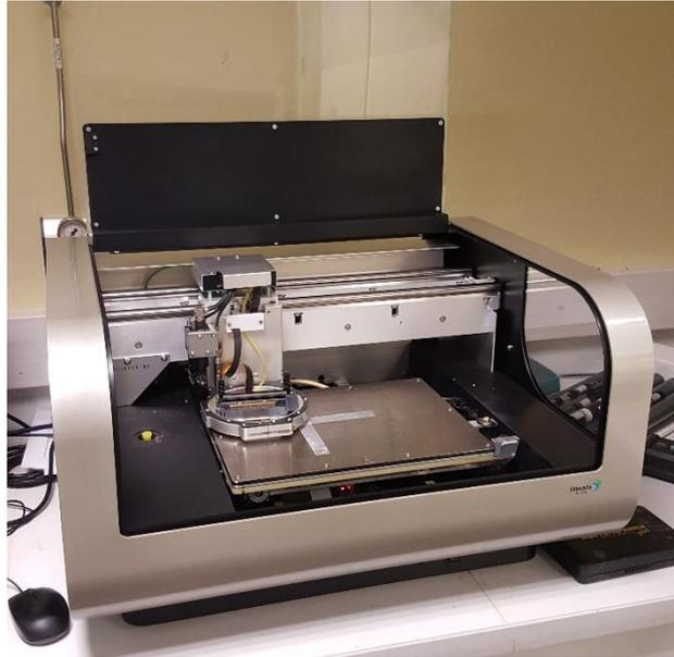
*Figure 90 : Imprimante DMP-2800 Series dans les locaux de XLIM*
