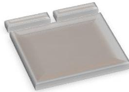
Figure 50 : Délimitation de la cathode par gravure de l'ITO (forme en T)
