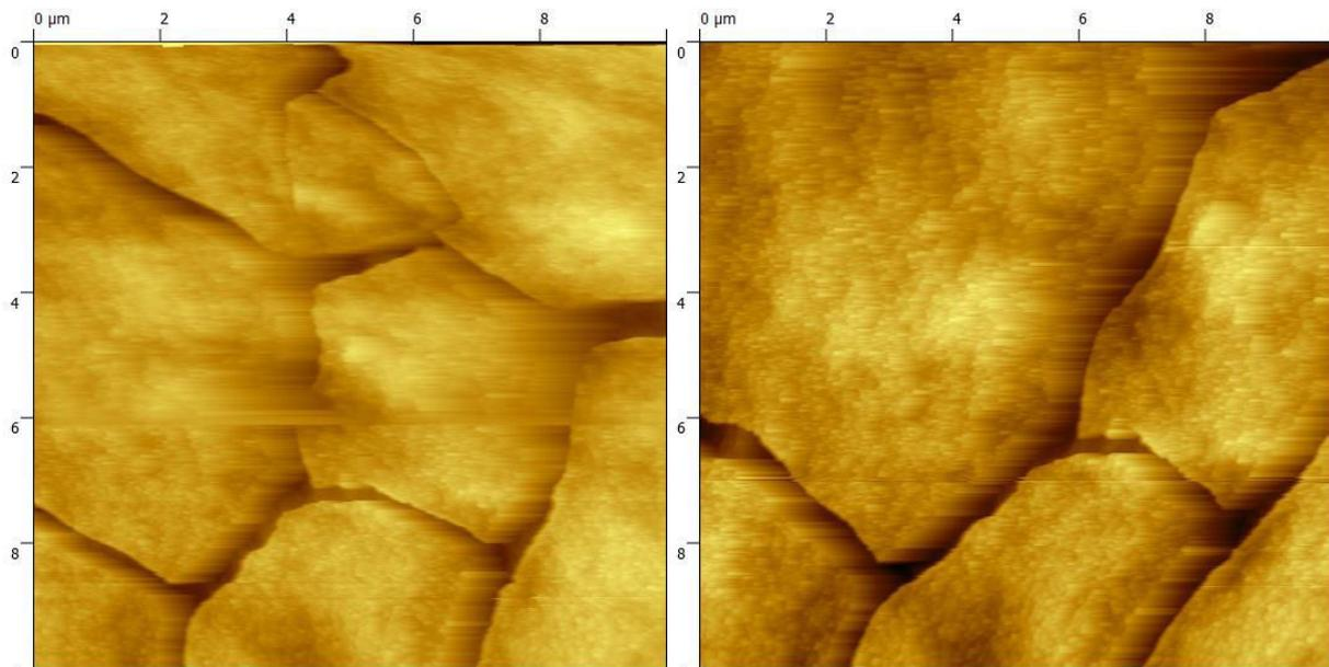
Figure 59 : Images topographique par AFM d'une couche de 20 nm de  $WO_3$
