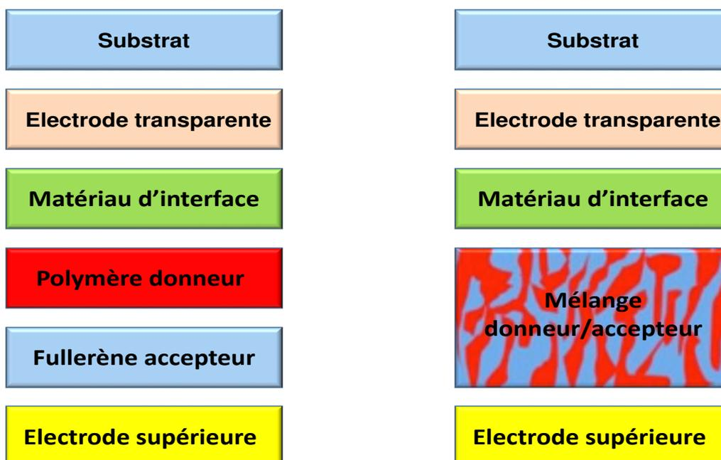
Figure 22 : Structure de cellules solaires (a) bicouche, (b) hétérojonction en volume
