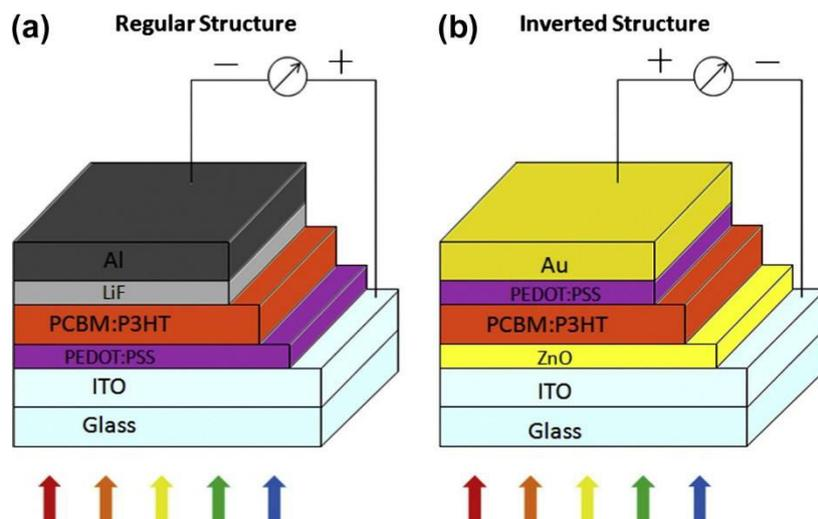
Figure 43 : Vue schématique d'une cellule solaire à structure standard (a) et d'une structure inverse (b)
