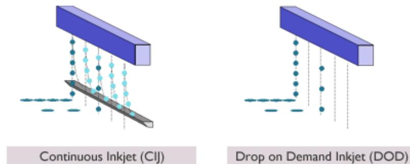
Figure 82 : Schéma des deux modes d'impression utilisés en industrie et en R&D <sup>254</sup>
