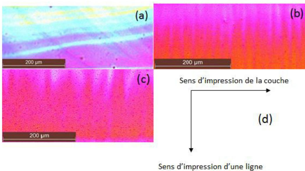
Figure 97 : Images des couches d'impression de  $WO_3$  en fonction de l'espacement de gouttes, (a)  $S \leq 30\mu\text{m}$ , (b)  $S = 45\mu\text{m}$ , (c)  $S = 41\mu\text{m}$ , (d) sens de l'impression
