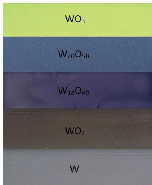
Figure 54 : Les différentes couleurs d'oxyde de tungstène en fonction de la vacance en oxygène<sup>235</sup>.
