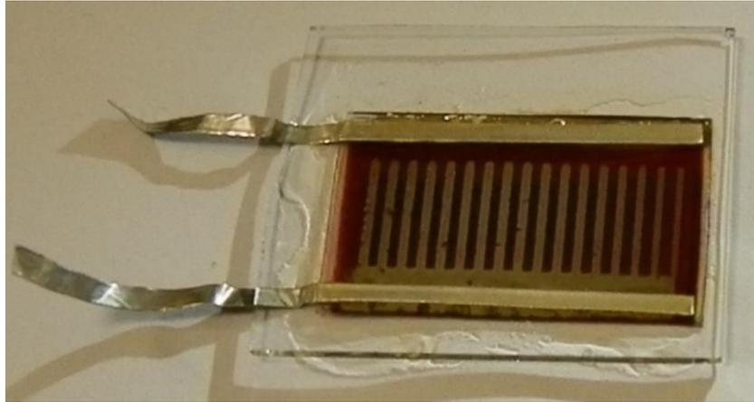
*Figure 77 : Image d'une cellule solaire 25 x 17 mm avec encapsulation en verre côté électrode supérieure*
