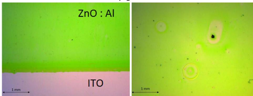
Figure 101 : Impression d'oxyde de zinc : à gauche avec nettoyage, à droite sans nettoyage
