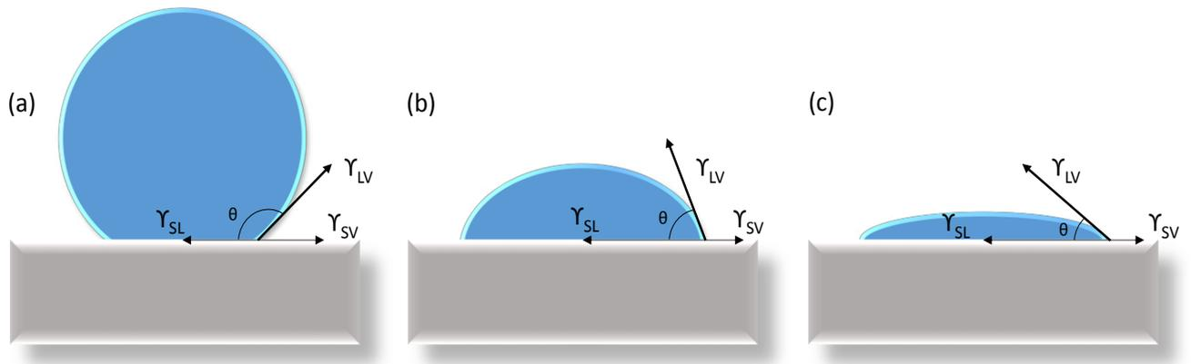
Figure 87 : Différents types de mouillabilité d'une encre sur un substrat et les forces interfaciales appliquées
