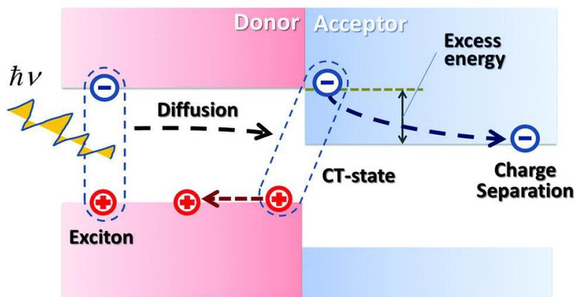
Figure 16 : Représentation des différentes étapes de la photoconversion<sup>35</sup>
