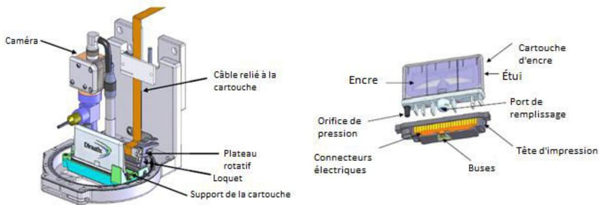
Figure 91 : Schéma du bloc d'impression (a) et du bloc de la cartouche d'impression (b) <sup>279</sup>
