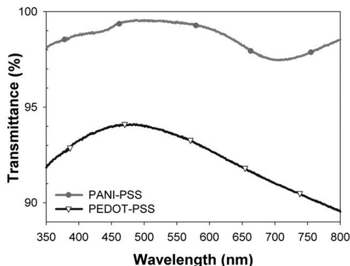
Figure 45 : Spectres de transmission du PANI : PSS et du PEDOT : PSS
