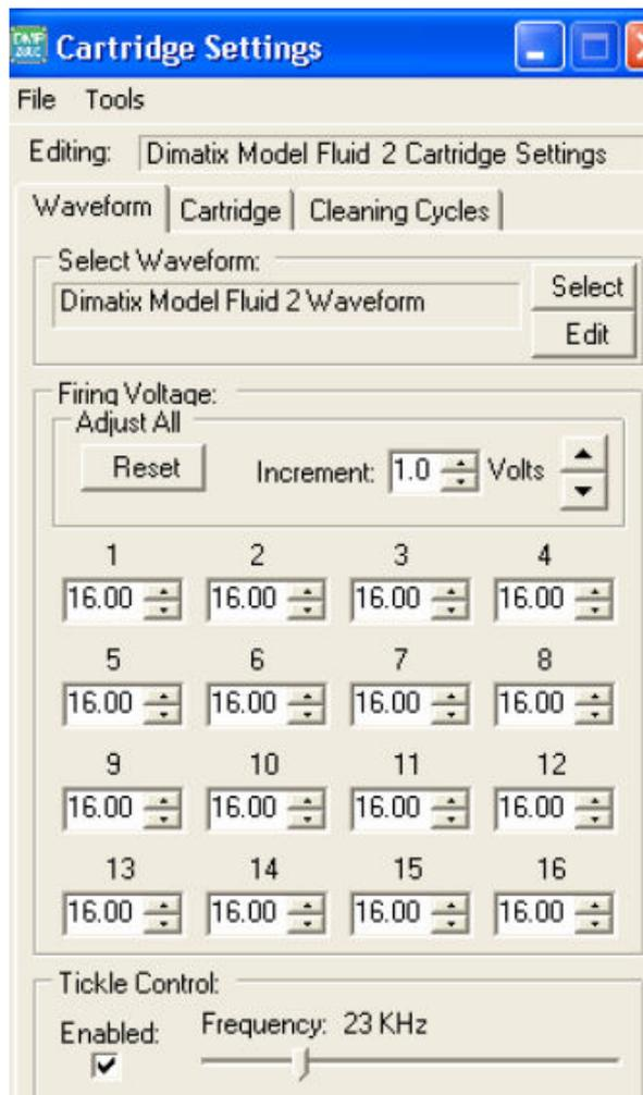
Figure 93 : Onglets de contrôle de la tension d'éjection des différentes buses de la cartouche d'impression
