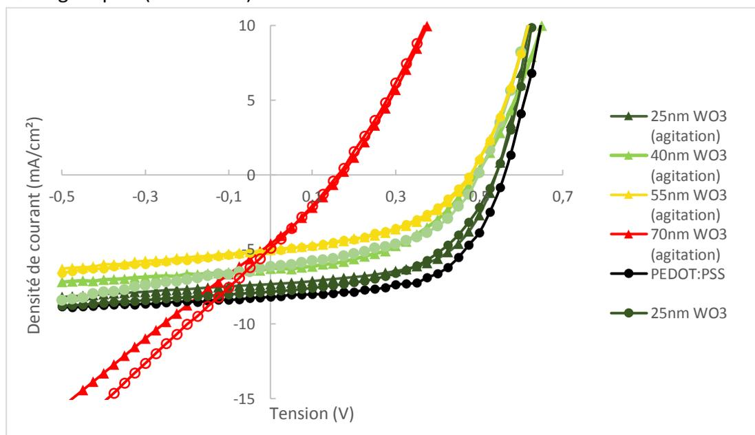
Figure 61 : Courbes J(V) des cellules solaires inversées avec et sans agitation magnétique au préalable de la solution de WO<sub>3</sub>
