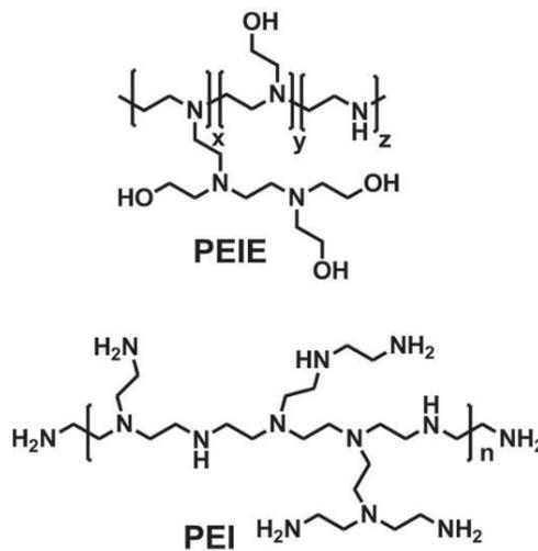
Figure 37 : Structure moléculaire de polyélectrolytes utilisés comme couche de transport d'électrons
