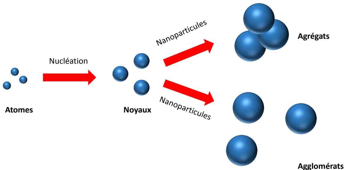
**Figure 62 : Les différentes étapes ascendantes d'élaboration de nanoparticules**
