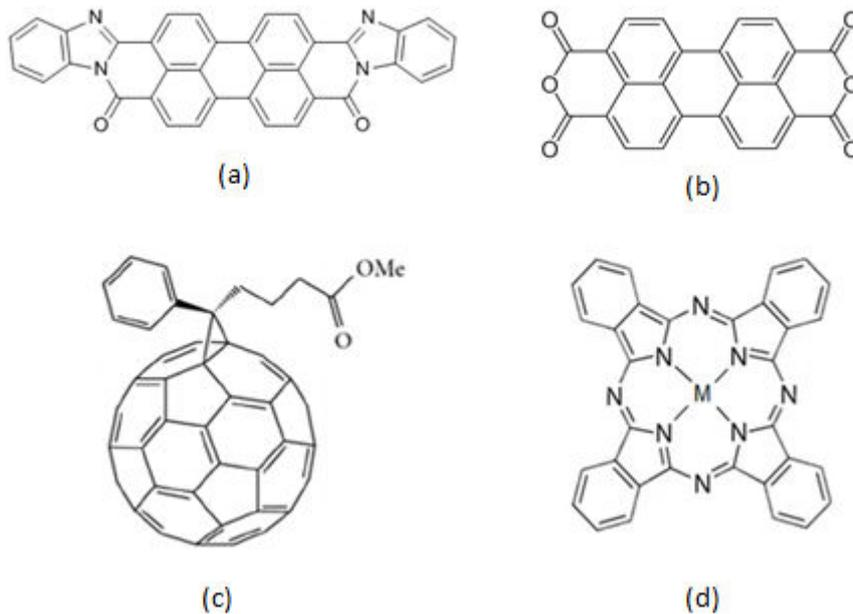
Figure 15 : Structure chimique de petites molécules couramment utilisées dans les cellules solaires organiques, (a) PTCBI, (b) PTCDA, (c) PC<sub>60</sub>BM, (d) MPc (M=Zn, Cu)
