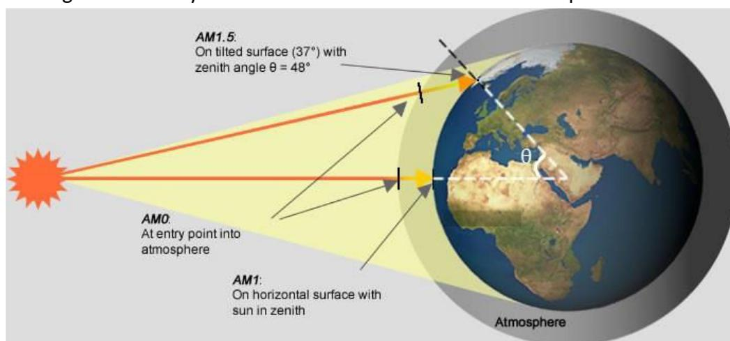
Figure 23 : Schéma des conditions d'illumination<sup>70</sup>
