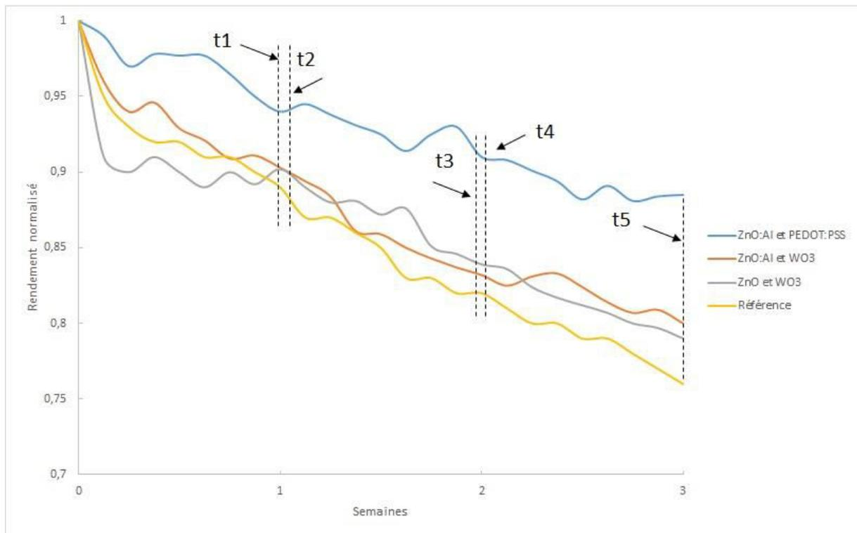
Figure 80 : Stabilité des cellules solaires organiques avec encapsulation côté électrode supérieure
