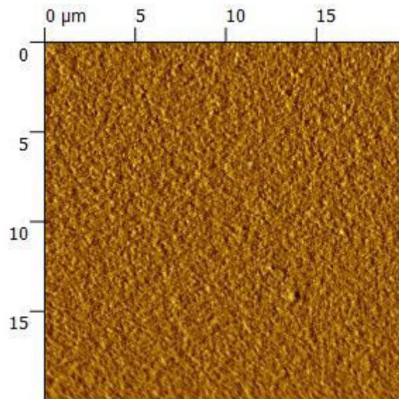
Figure 65 : Répartition de la solution de nanoparticules de  $WO_3$  sur la couche active P3HT : PCBM après agitation ultrasonique
