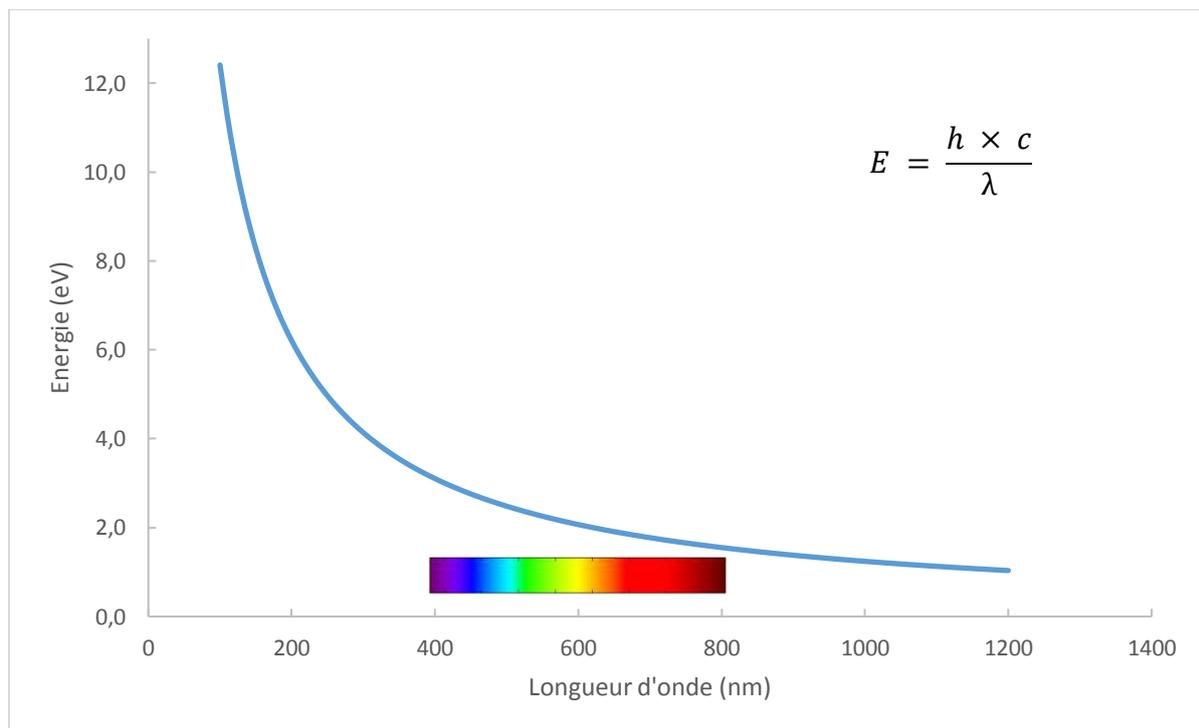
Figure 13 : Graphique du gap énergétique en fonction de la longueur d'onde
