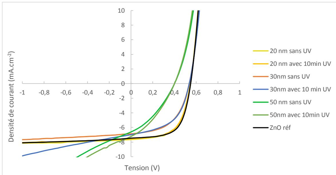
Figure 69 : Courbes J(V) des cellules solaires à base de ZnO : Al et comparaison avec le ZnO de référence (20 nm d'épaisseur)
