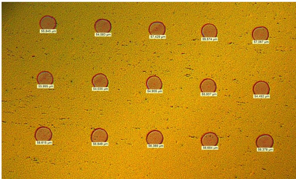
Figure 95 : Exemple de mesure du diamètre de « splat », ici des gouttes de WO<sub>3</sub> déposées sur un substrat plastique avec la structure PET / ITO / ZnO : Al / P3HT : PCBM
