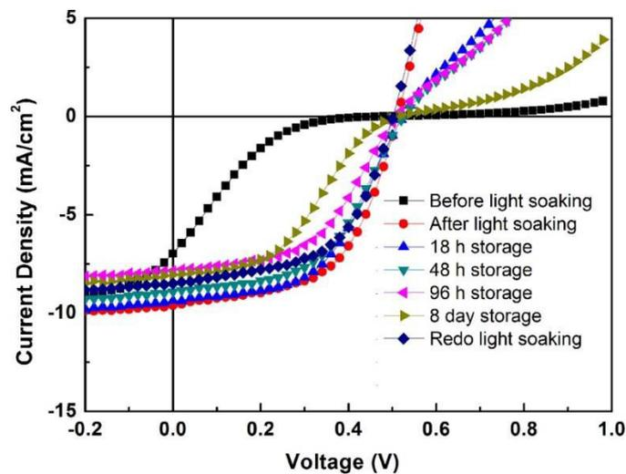
Figure 40 : Courbes  $J(V)$  d'une cellule à différents temps de stockage en boîte à gants
