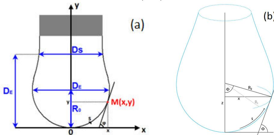
Figure 84 : Schéma de la goutte pendante et système de coordonnées (a) avec en gris l'embout de la seringue, (b) représentation des rayons de courbure  $R_1$  et  $R_2$  au point tangent de la goutte
