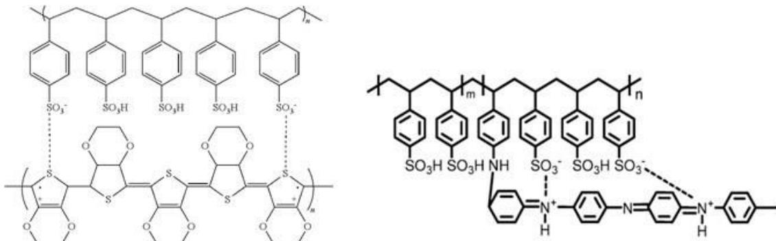
Figure 44 : Structure des deux principaux polymères utilisés comme couche de transport de trous dans les cellules solaires organiques, à gauche le PEDOT : PSS, à droite le PANI : PSS
