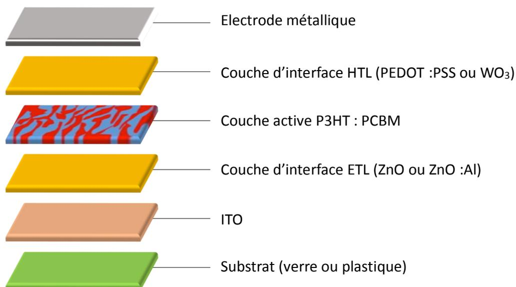
Figure 48 : Structure inverse d'une cellule solaire organique
