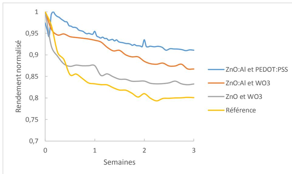
Figure 81 : Stabilité des cellules solaires organiques des différentes architectures étudiées avec une double encapsulation
