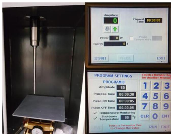
Figure 63 : Représentation de la sonde ultrasonique et du porte substrat réglable (à gauche), du procédé continu en réglant l'amplitude (en haut à droite), du procédé continu ou alternatif en réglant le temps, l'amplitude et le contrôle de la température (en bas à droite).
