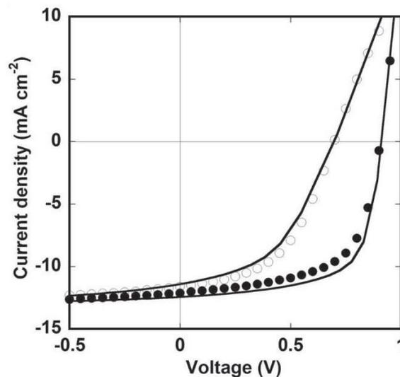
Figure 35 : Effet de la couche d'interface de PFN sur les performances d'un dispositif à base de PCDTBT : PC<sub>71</sub>BM, la courbe  $J(V)$  avec des cercles pleins avec PFN et la courbe  $J(V)$  avec des cercles vides sans PFN<sup>14</sup>
