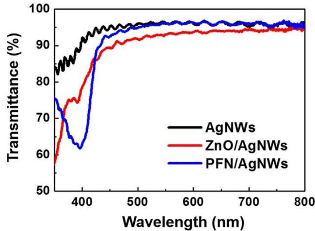
Figure 36 : Transmission des couches de nanofils d'argent, de la combinaison ZnO/nanofils d'argent et de la combinaison de PFN/nanofils d'argent<sup>15</sup>
