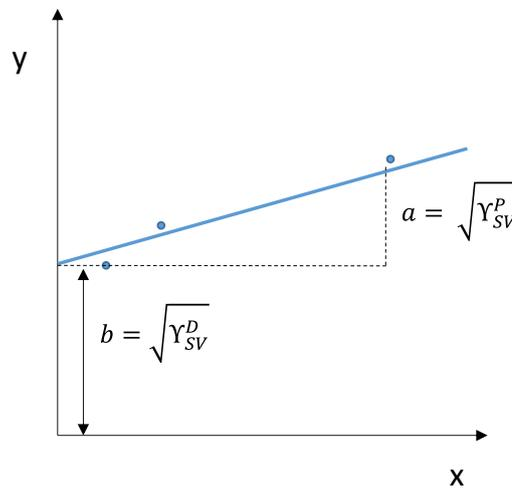
Figure 89 : Régression linéaire pour la détermination de l'énergie de surface d'un matériau
