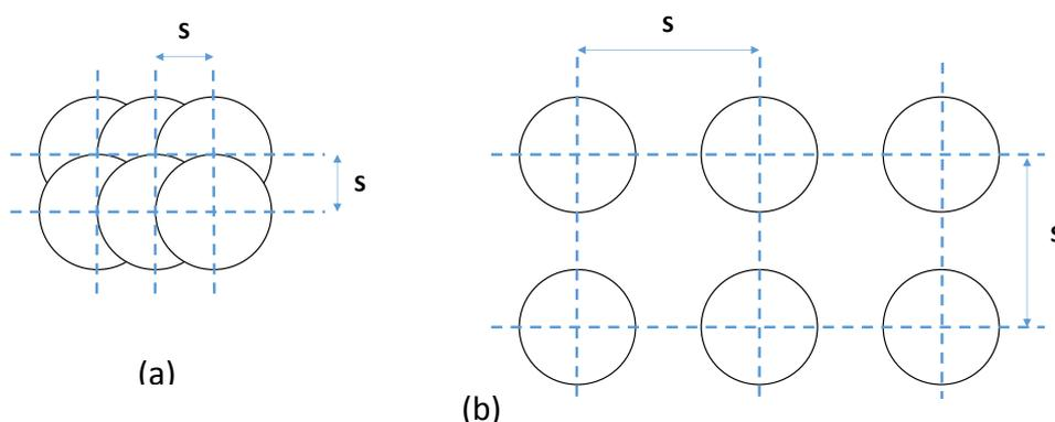
Figure 96 : Modèle d'impression selon l'espacement des gouttes, (a)  $S < D$  et (b)  $S > D$
