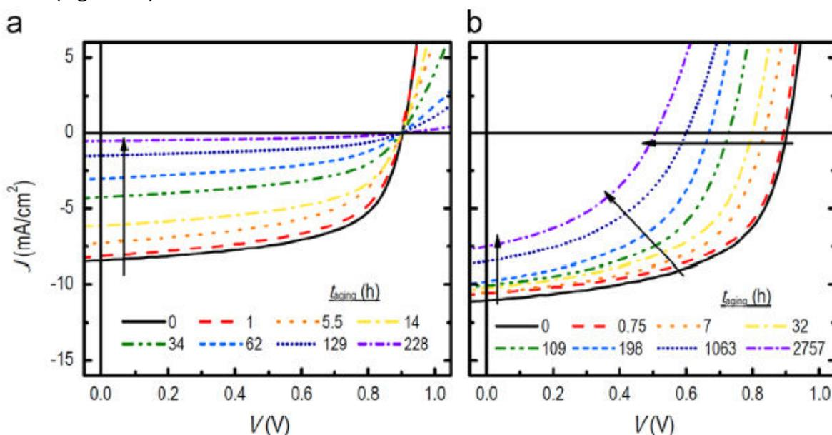
Figure 33 : Evolution des courbes  $J(V)$  des cellules solaires organiques (a) structure standard, (b) structure inversée
