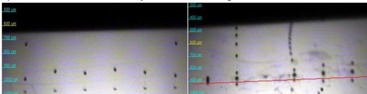
Figure 94 : Vue d'une éjection de l'encre  $WO_3$ , à gauche une bonne éjection, à droite une mauvaise éjection dont 2 buses bouchées et 2 autres buses où le profil d'éjection des gouttes est trop rapide, la ligne rouge représente le plan miroir de la tête d'impression
