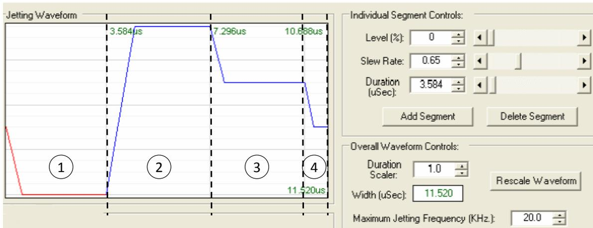
Figure 98 : Forme d'onde typique et les différents paramètres ajustables
