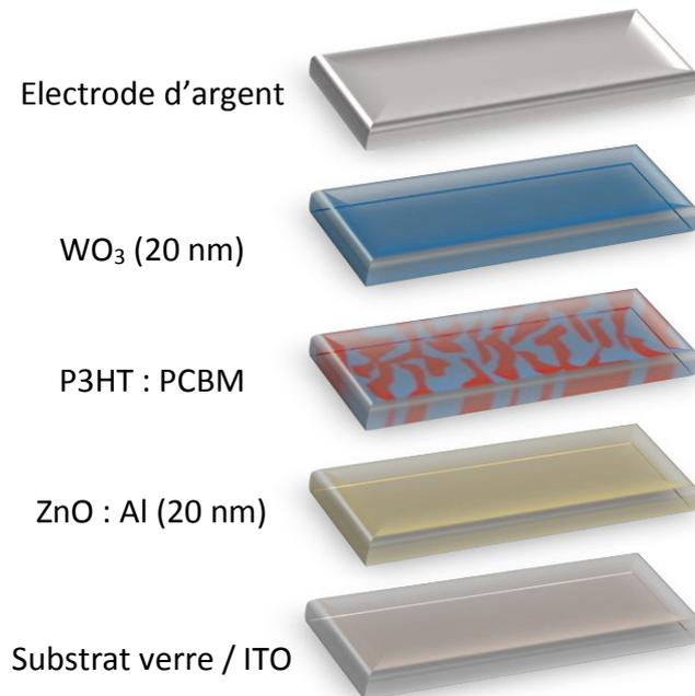
*Figure 70 : Architecture des cellules solaires avec les épaisseurs optimisées du WO<sub>3</sub> et du ZnO : Al*
