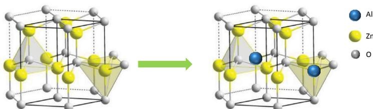
Figure 20 : Structure cristalline du ZnO de type wurtzite avec sites tétraédriques à gauche et structure cristalline du ZnO après dopage avec un atome d'aluminium à droite.
