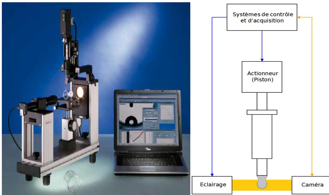
Figure 85 : Image et schéma de la mesure de la tension de surface effectuée à l'aide du logiciel OCA 20 EC
