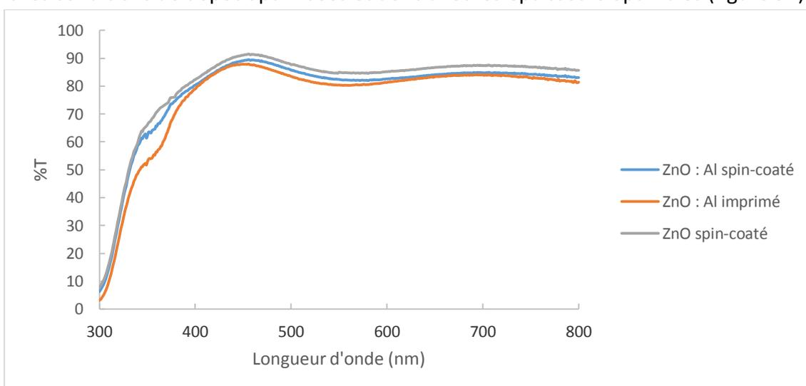
Figure 102 : Courbes de transmission des épaisseurs optimales (20 nm) des différents oxydes de zinc et leur mode de dépôt
