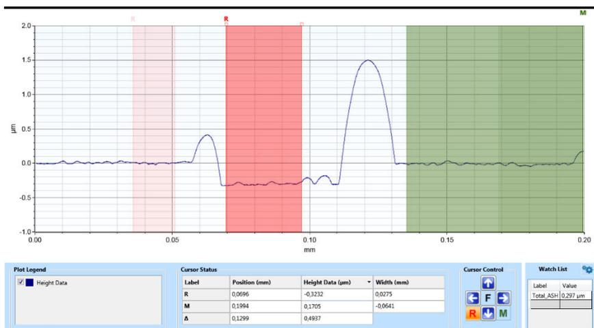
Figure 55 : Mesure de l'épaisseur du  $WO_3$  par profilométrie
