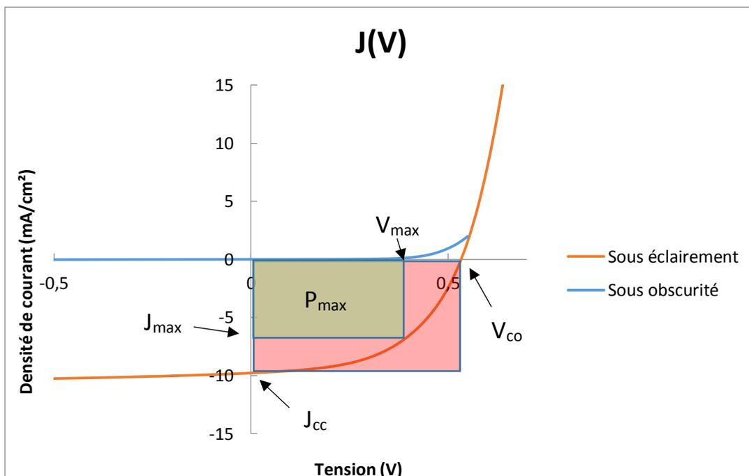
Figure 24 : Courbe caractéristique courant-tension d'une cellule photovoltaïque de référence à base de P3HT : PCBM à l'obscurité et sous éclairement
