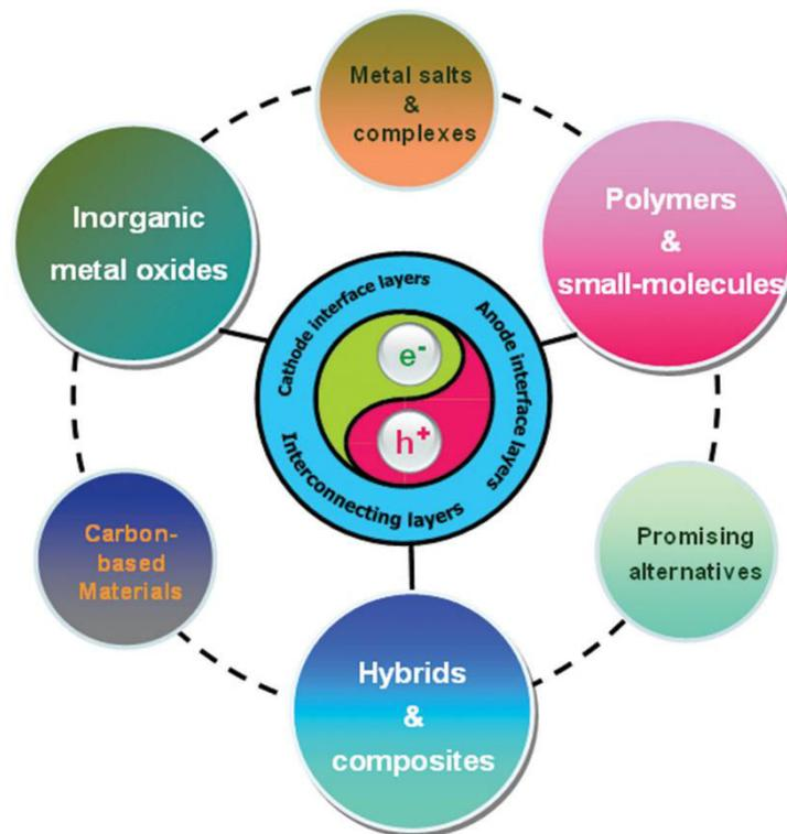
Figure 34 : Catégories de matériaux d'interface utilisées dans l'élaboration de cellules solaires organiques<sup>108</sup>
