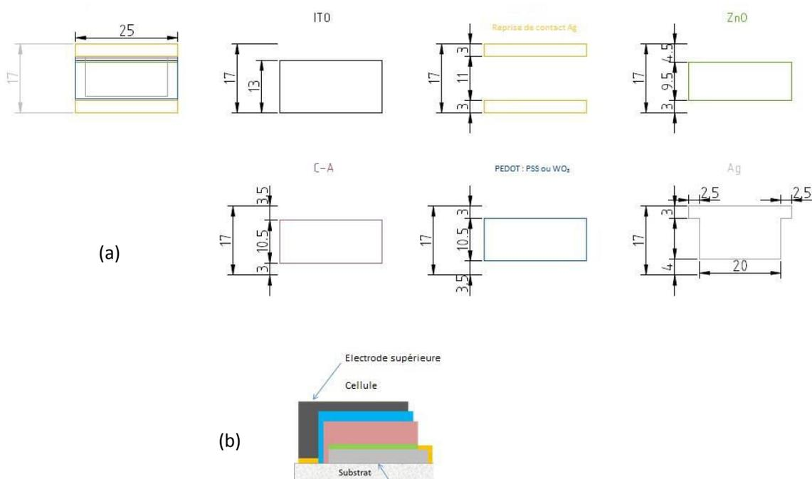
Figure 74 : Vue schématique d'une cellule 25 x 17 mm avec les différentes couches déposées, (a) vue de dessus, (b) vue de profil
