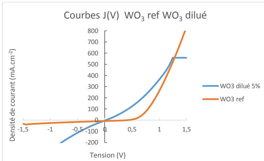
Figure 66 : Courbes J(V) des cellules à base de  $WO_3$  avec et sans dilution
