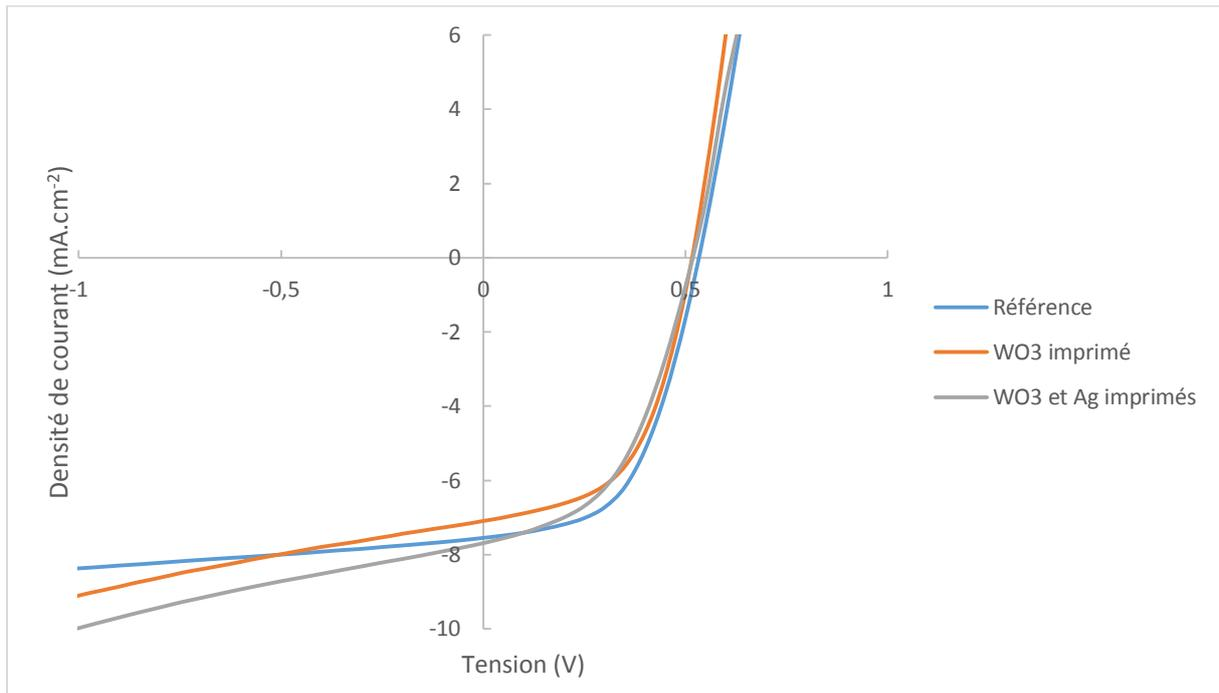
Figure 100 : Caractéristiques de courbes J(V) en fonction du nombre de couches imprimées
