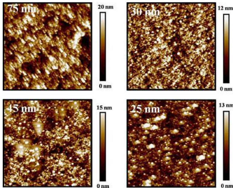
Figure 39 : Images AFM ( $1 \times 1 \mu\text{m}^2$ ) des couches de ZnO avec différentes épaisseurs déposées sur verre/ITO
