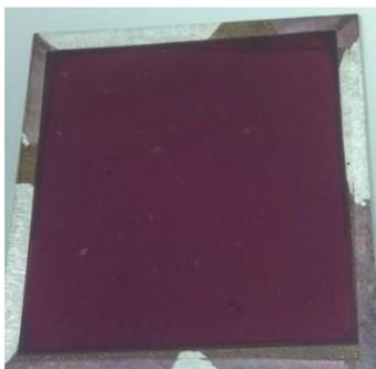
Figure 75 : Plaque PET/ITO/ZnO/Couche active/WO<sub>3</sub> munie d'un support métallique
