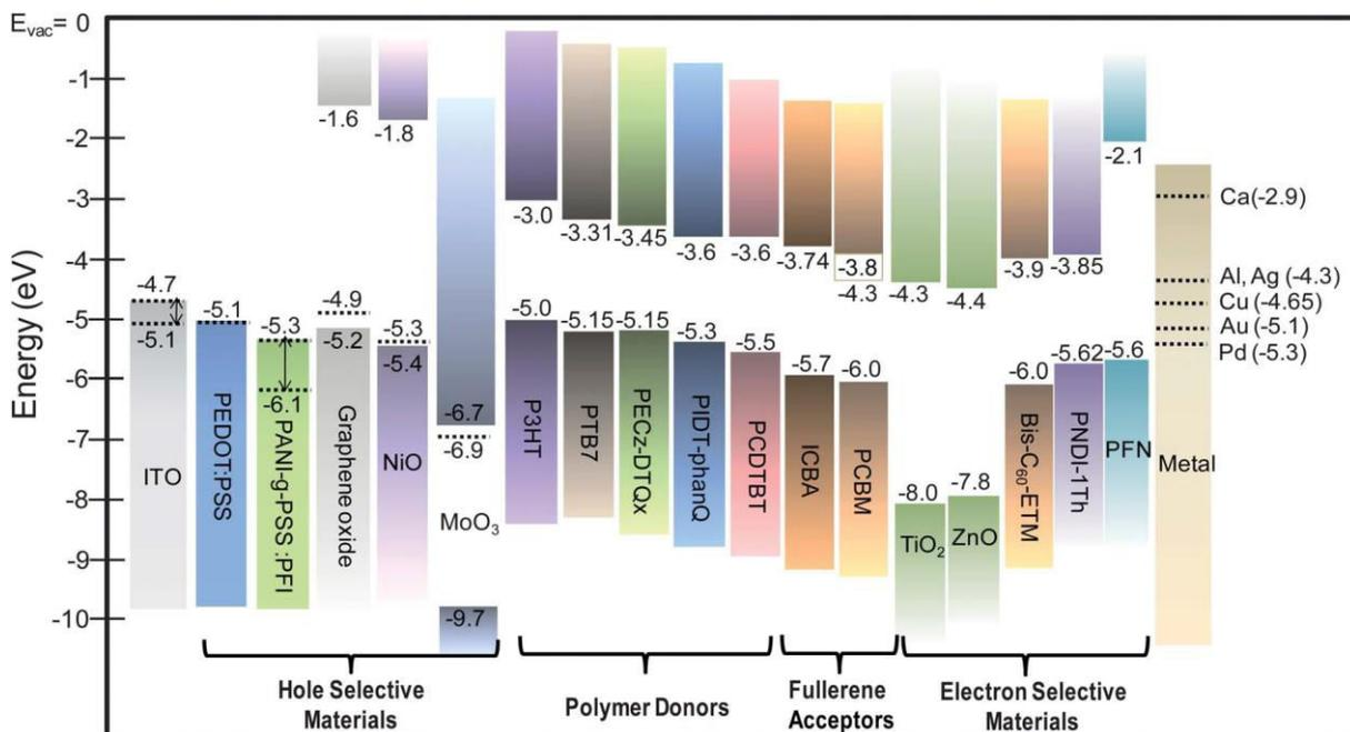
Figure 29 : Vue schématique des niveaux d'énergie de quelques matériaux utilisés dans l'élaboration de cellules solaires organiques tels que des oxydes métalliques ou des polymères.<sup>98</sup>
