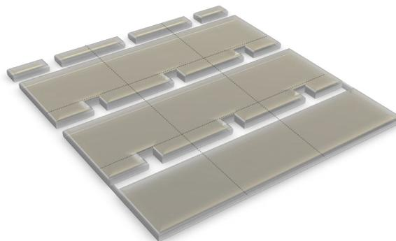
Figure 71 : Design d'une plaque de 5 x 5 cm PET/ITO après photolithographie. Les pointillés montrent la zone de découpe pour obtenir 9 cellules 12 x 12 cm.
