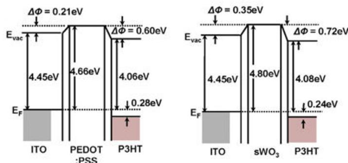
Figure 46 : Diagramme de niveau d'énergie d'une cellule solaire standard : à gauche avec du PEDOT : PSS et à droite avec du WO<sub>3</sub> en solution,  $E_{vac}$  est le niveau de vide,  $E_F$  le niveau de Fermi,  $\Delta\phi$  le changement de travail de sortie<sup>169</sup>
