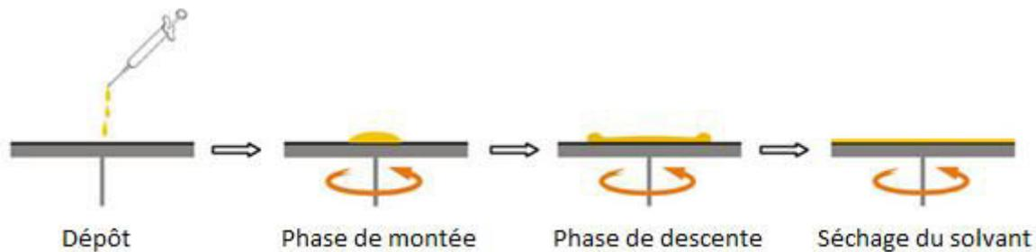
Figure 52 : Les différentes étapes durant le procédé par centrifugation
