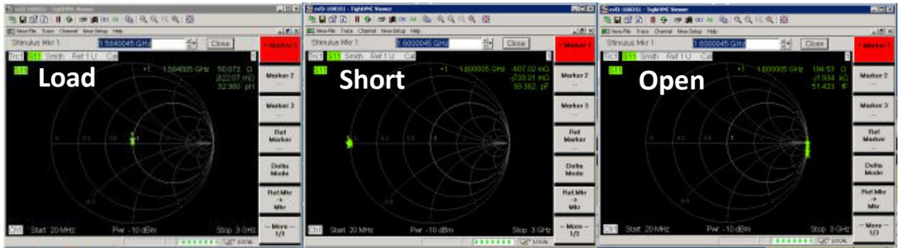
Figure IV. 11 : Résultat d'étalonnage à distance en standard SOLT
