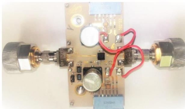
Figure III. 42 : Photographie de l'amplificateur large bande 10W [6 – 9 GHz]
