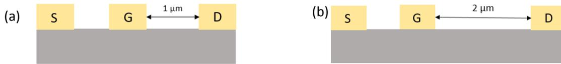
Figure 3.29 : Représentation de la distance entre la grille et drain pour la structure DHFET (a) et de la HEMT dopée Carbone (b).
