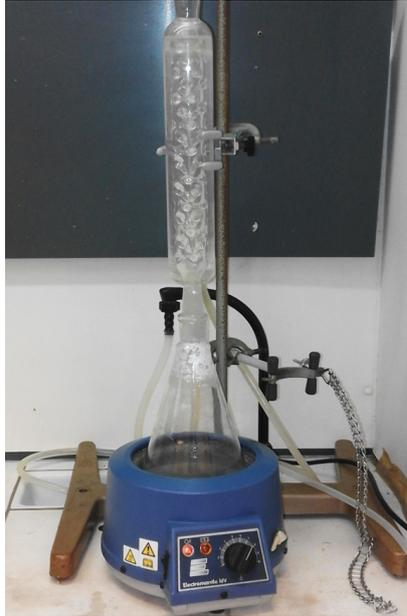
Figure 6.9 – Montage utilisé pour la réalisation du test CHAPELLE
