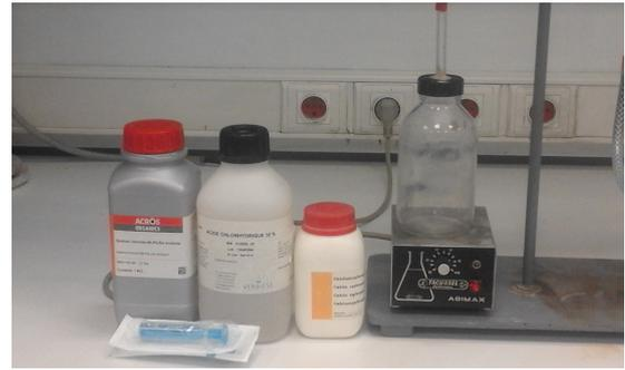
**Figure 5.42** – Montage de l'essai de détermination du taux de carbonates.
