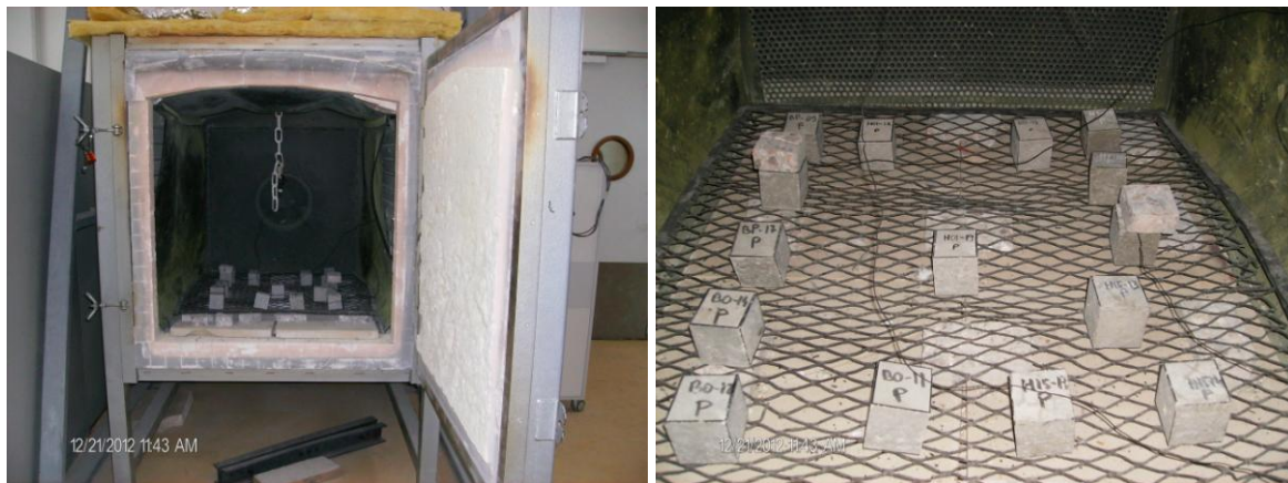
Figures III. 36. Four électrique programmable de dimension 1,3 x 1,04 x 1,04 m
