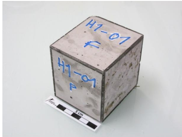
Figure III. 6. Cube 7x7x7 cm découpé à partir de l'éprouvette 7x7x28 cm.
