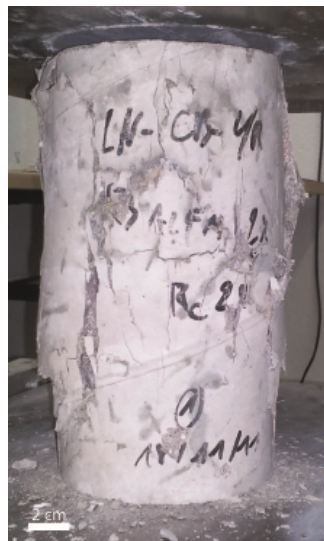
Figure II. 10. Test de compression simple réalisée sur un béton AC-2.
