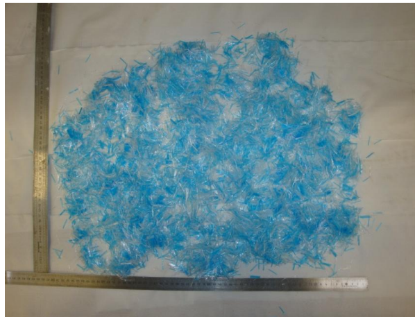
Figure II. 7. Fibres de polypropylène utilisées (EURO320DC)
