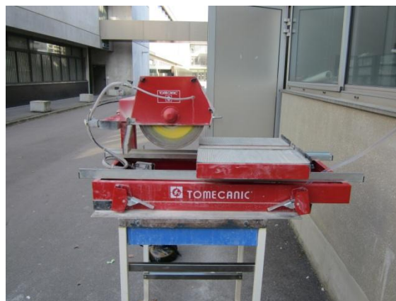
Figure III. 5. Scie ayant servi au découpage des éprouvettes 7 \times 7 \times 28 cm en 7 \times 7 \times 7 cm.
