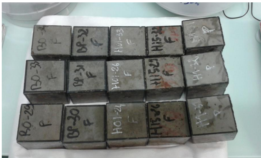
Figure III. 14. Photos des échantillons juste à leur sortie de la solution saline après 18 mois d'immersion totale et avant l'écrasement à la compression
