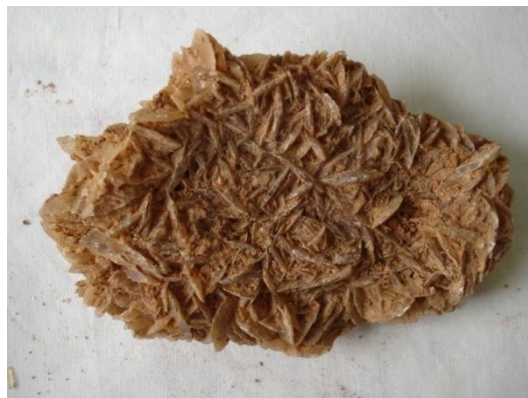
Figure III. 2. Echantillons de roches gypseuses (rose des sables de 20cm de long et 10 cm de large) qui existent dans les sols algériens
