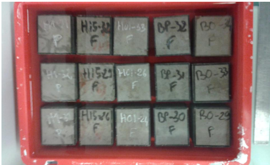
Figure III. 8. Immersion des échantillons de béton dans la solution saline à 12,5% en masse de Na 2 SO 4
