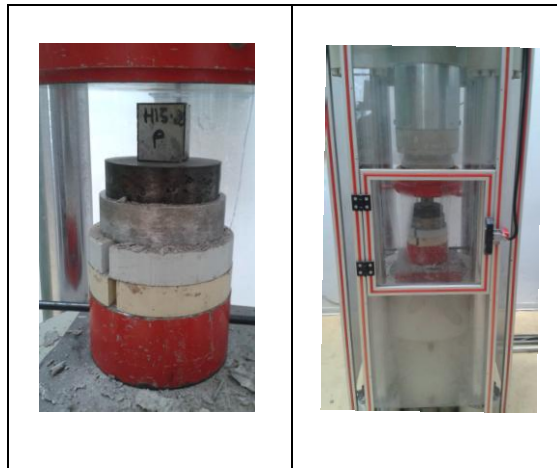
Figure III. 12. Tests de compression simple des échantillons
