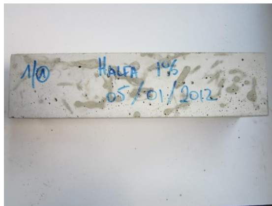
Figure III. 4. Echantillons de bétons de dimension 7 \times 7 \times 28 cm.
