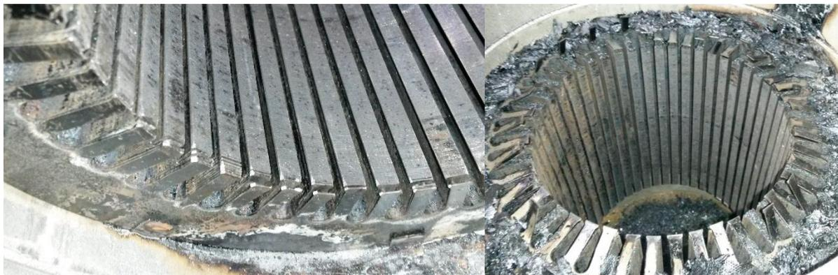
Figure IV.27 : Photographies de l'état du circuit magnétique statorique de la MAS11kW4pC-IE3 suite à l'extraction des bobines anciennes
