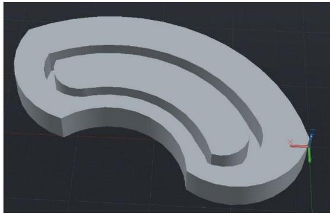
Figure II.28 : Croquis du capteur polaire utilisé pour la mesure du flux de dispersion axial rayonné par un moteur asynchrone 11kW – 4 pôles – IE2
