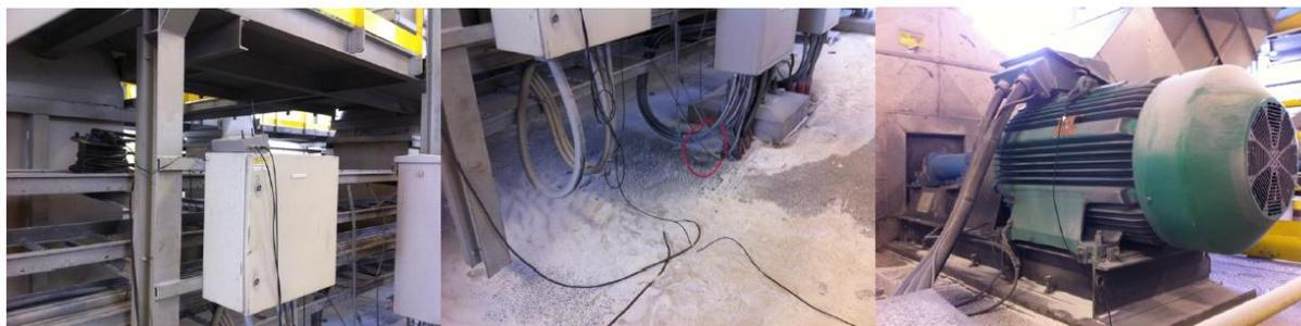
(a) Cellule de collecte/transmission (b) Mesure du courant avec une sonde placée sur une des phase du moteur (c) Captation du flux de dispersion
