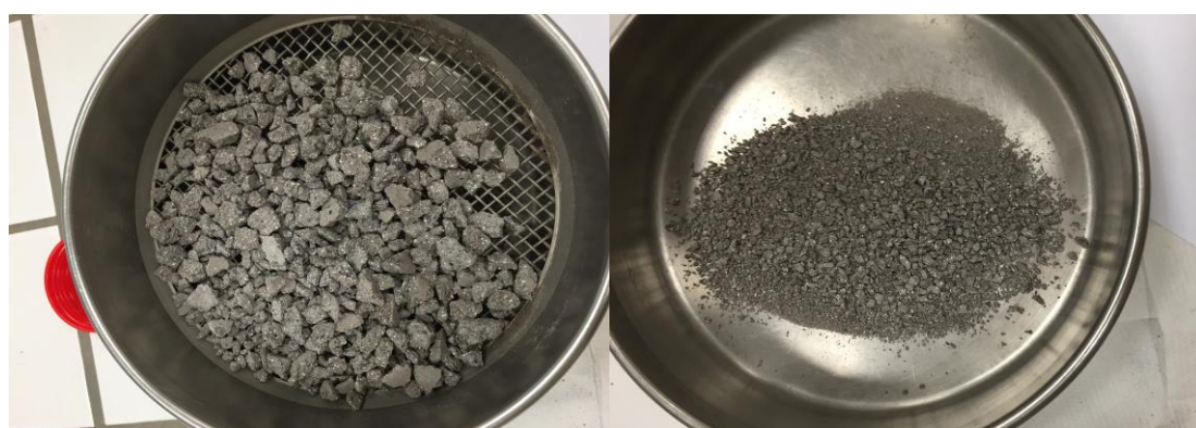
Figure 73 : Photos de l'étape de séparation entre 0 et 4mm
