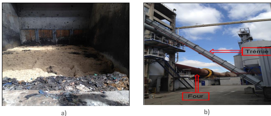
Figure 43 : Photos de la préparation des formulations : a) Formulation MR6_bis mélangé avec les combustibles secondaires ; b) Formulation MR6_bis acheminée vers l'entrée du four rotatif sur une trémie
