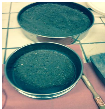
Figure 68 : Photo du tamisage des résidus de combustion <7mm
