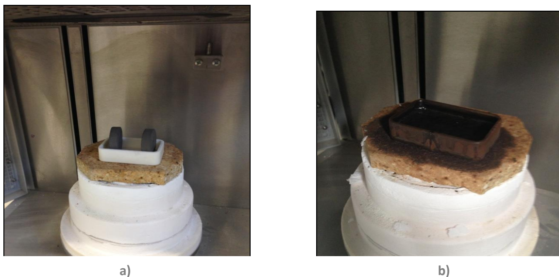
Figure 48 : Formulations MR6_bis « calcaire + sédiments fluviaux » à gauche et MR7_bis « calcaire + FAC » à droite pastillées a) avant cuisson ; b) après cuisson
