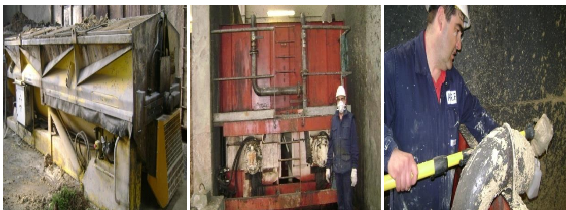
Figure 50 : Photos des trémies utilisées pour les essais industriels et du prélèvement du cru pour une caractérisation en laboratoire (à droite)
