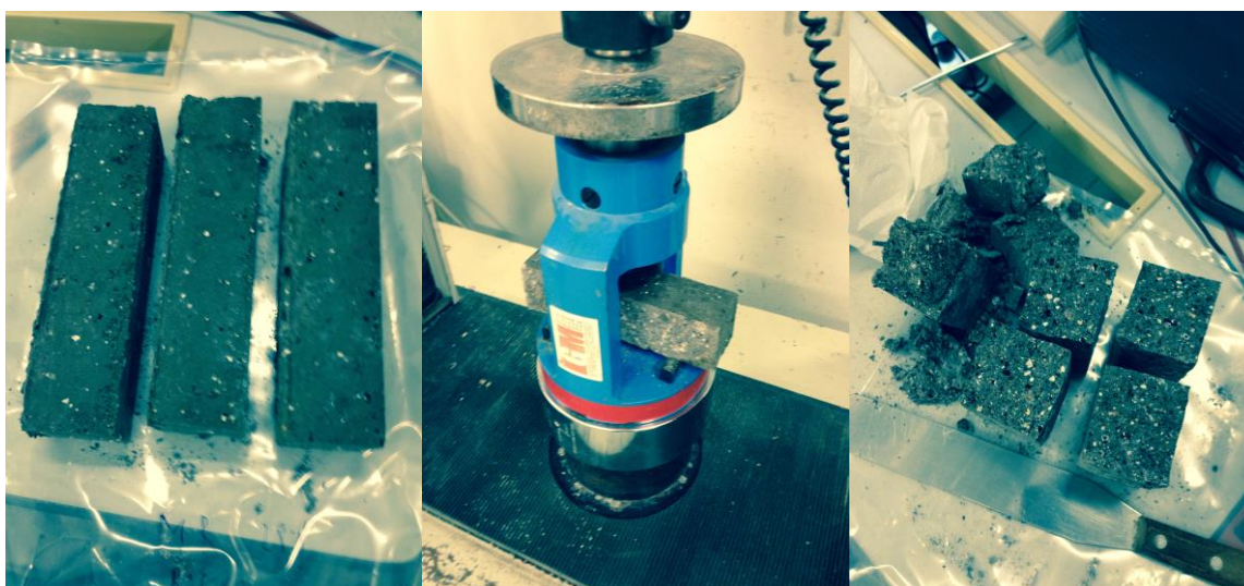
Figure 71 : Photos lors de la casse des éprouvettes à la flexion et en compression
