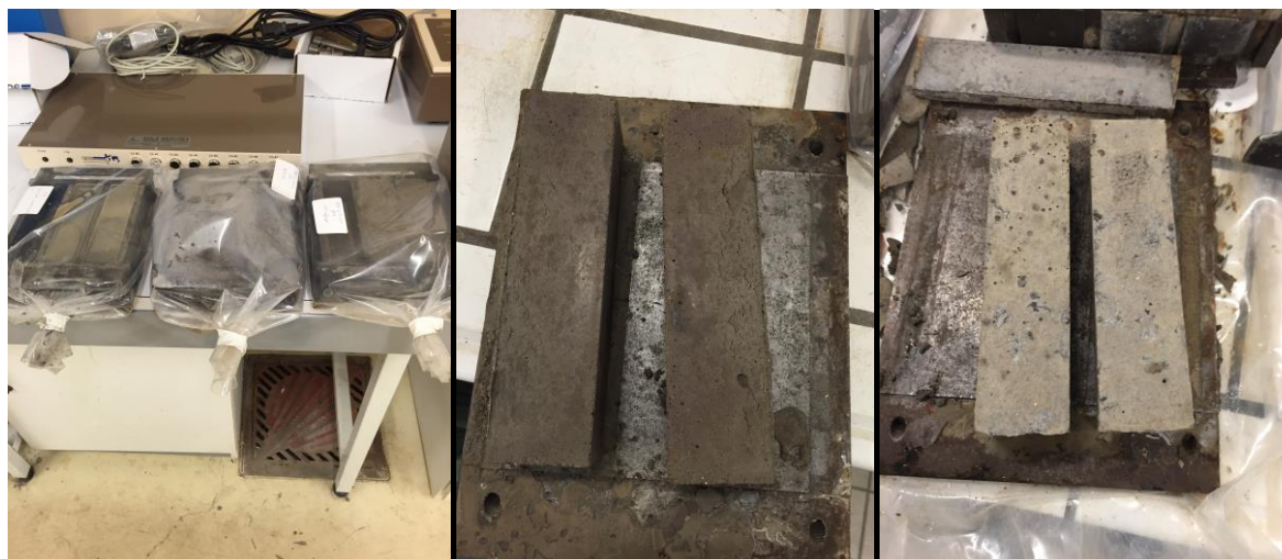
Figure 75 : Photos lors de la confection et du démoulage des éprouvettes
