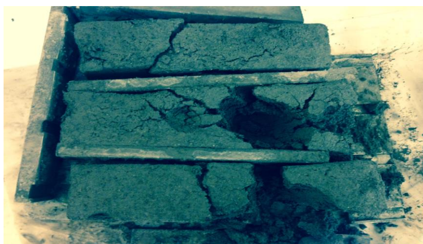
Figure 70 : Photo prise lors du démoulage des éprouvettes RDC <0,5mm
