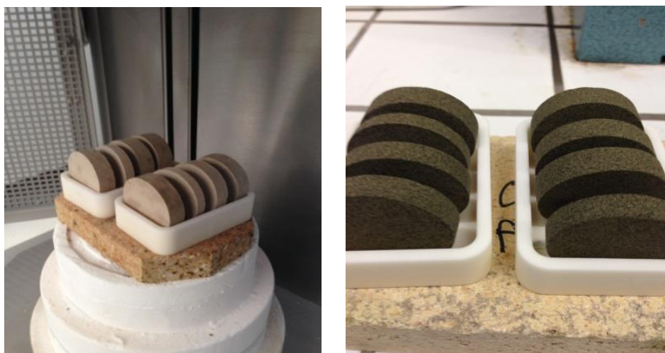
Figure 8 : Pastilles avant (à gauche) et après cuisson à 1450°C (à droite)
