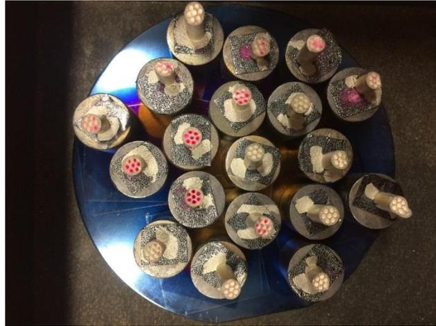
Figure II-15 : Métallisation des échantillons de membranes analysés au MEB
