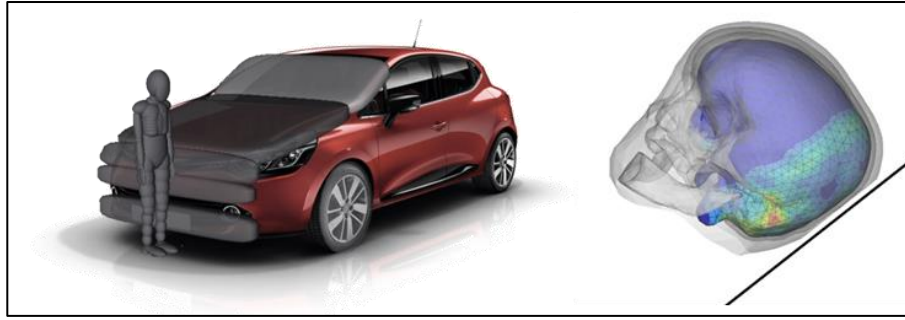
Figure 22. Modélisation multi-corps (à gauche) et éléments-finis (à droite)
