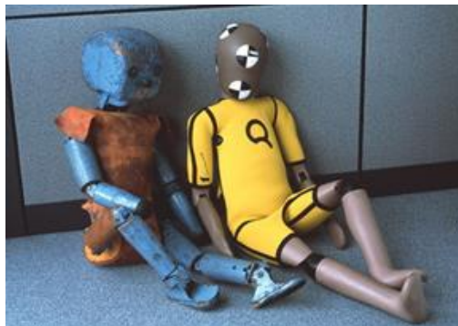
Figure 17. Evolution des mannequins (P6 à gauche, Q6 à droite)
