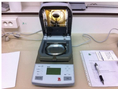
Figure 76: Balance infrarouge Ohaus type MB45 pour mesure de l'humidité résiduelle
