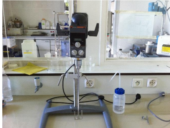
Figure 77 : Agitateur Heidolph RZR 2041 munie d'une pale en forme d'ancre
