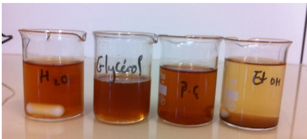
Figure 81 : Essais de solubilisation du lyophilisat d' Afzelia africana dans l'eau, le glycérol, le propylène glycol (PG) et l'éthanol 96°(EtOH).
