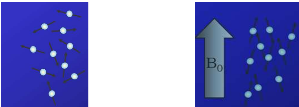
Figure C 1 Orientations des spins nucléaires sans champ magnétique appliqué (à gauche) 1a et en présence d'un champ appliqué B (à droite).
