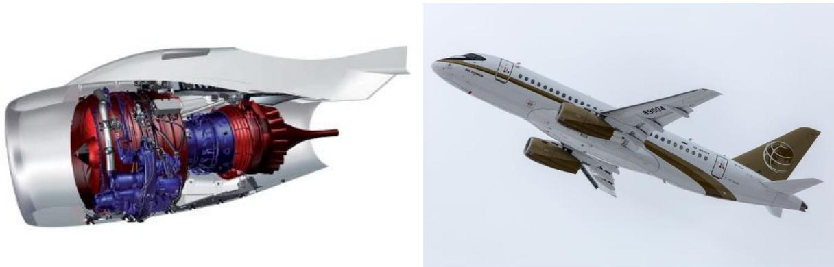
Figure 2.2. Coupe du SaM146 et vue en vol du Superjet SSJ100 équipé du SaM146-1S17.
