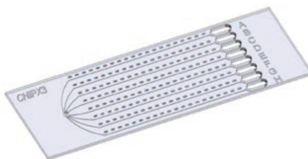
**Figure 4.3.1: Puces micro-fluidiques ChipX-3.** La protéine est injectée dans les 8 canaux à partir de l'entrée à gauche. A droite, les 8 réservoirs (A à H) permettent de tester 8 conditions de cristallisation par diffusion contraire.
