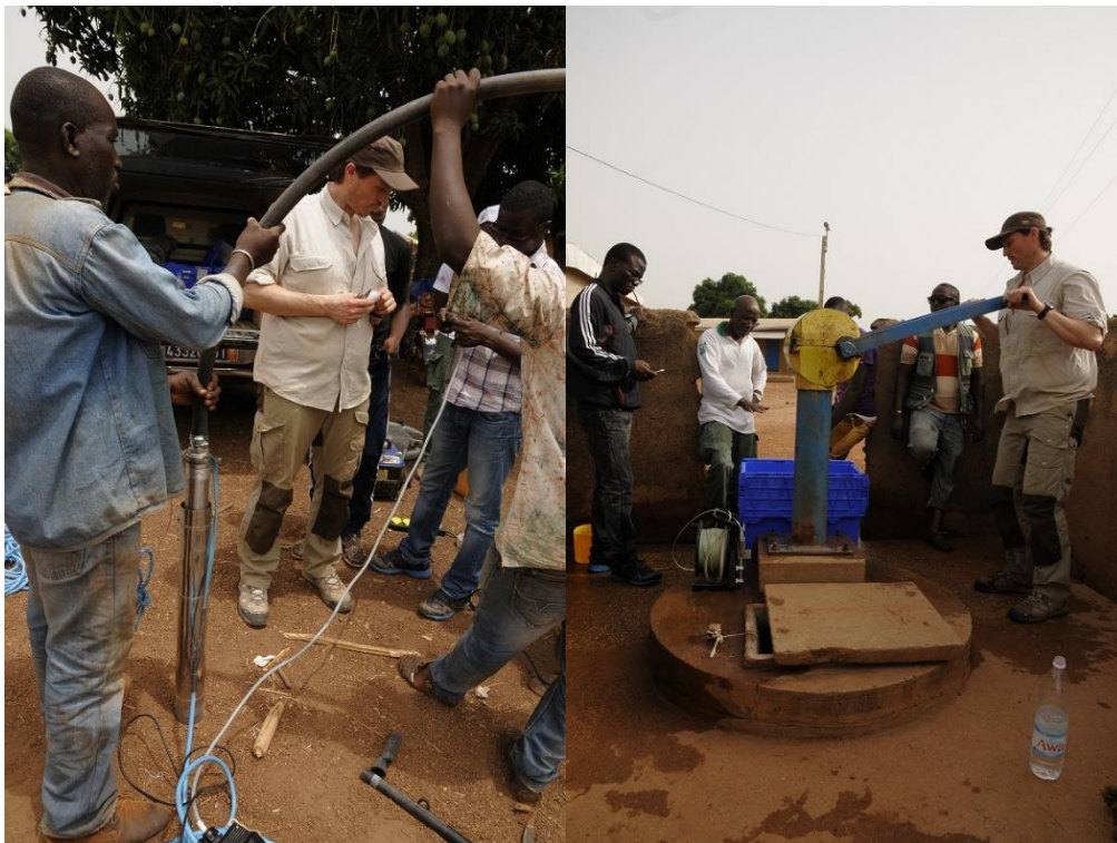
Figure 33 : Photo d'essais de pompage (pompe immergée / pompage manuel)
