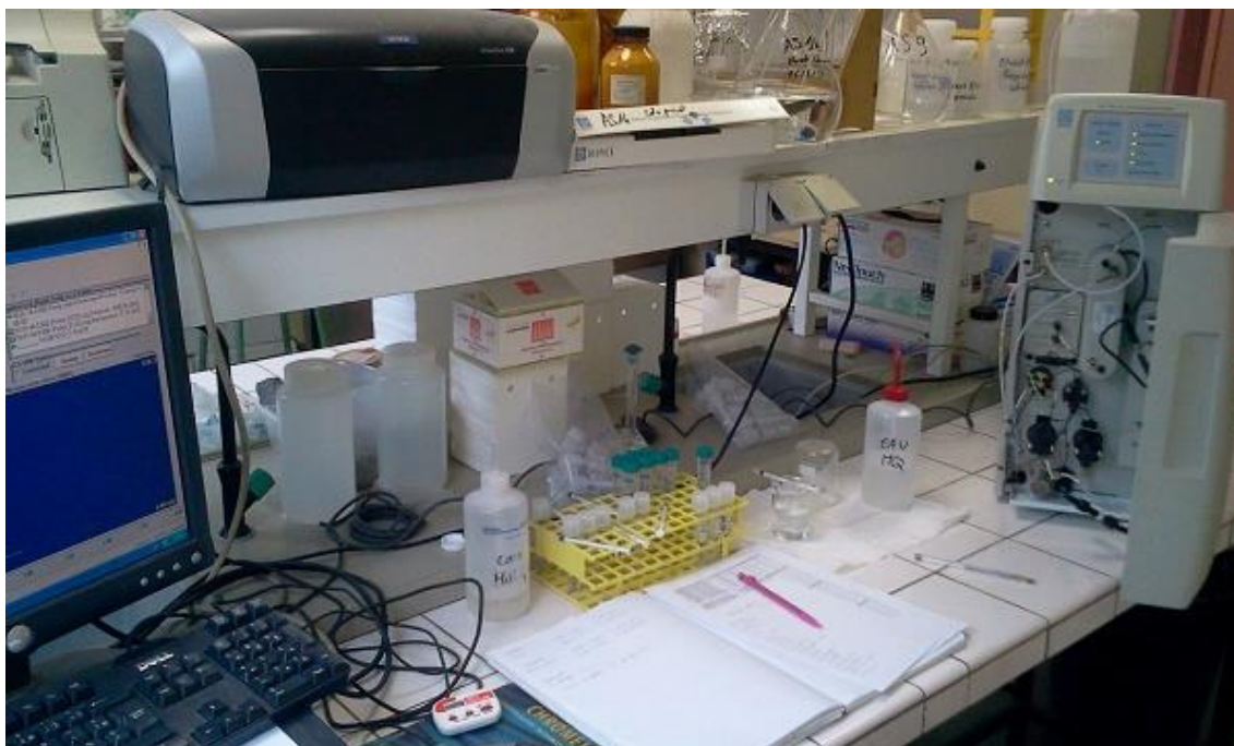
Figure 30 : Photo du dosage des anions majeurs avec l'ISC-1000 au laboratoire GEOPS
