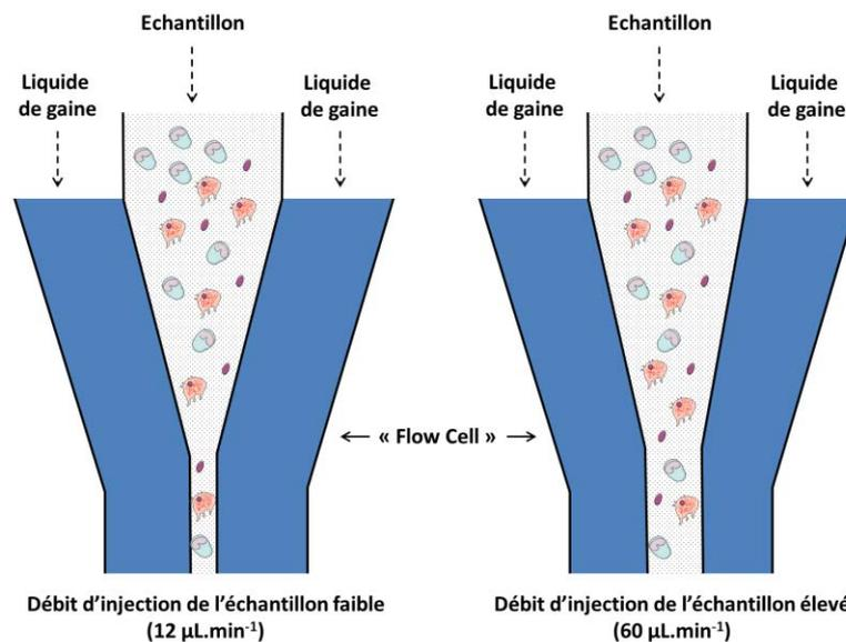
Figure 2. 1 : « Flow cell » où l'échantillon contenant la suspension cellulaire est injecté via le liquide de gaine. La réduction du diamètre en sortie de la « flow cell » entraîne une accélération du liquide de gaine contenant l'échantillon en son centre ce qui permet la séparation des particules. Illustration adaptée d'après Givan, 2004.
