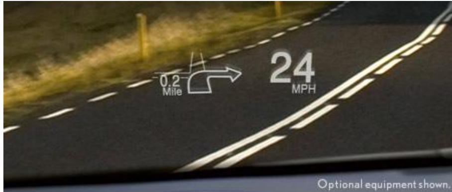
Figure 2. HUD de la Lexus RX. Affichage des instructions de navigation et de la vitesse du véhicule
