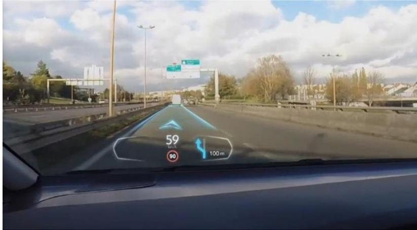
Figure 5. Projet de réalité augmentée de PSA : le marquage au sol est augmenté afin de mettre en évidence la trajectoire à suivre.<sup>4</sup>
