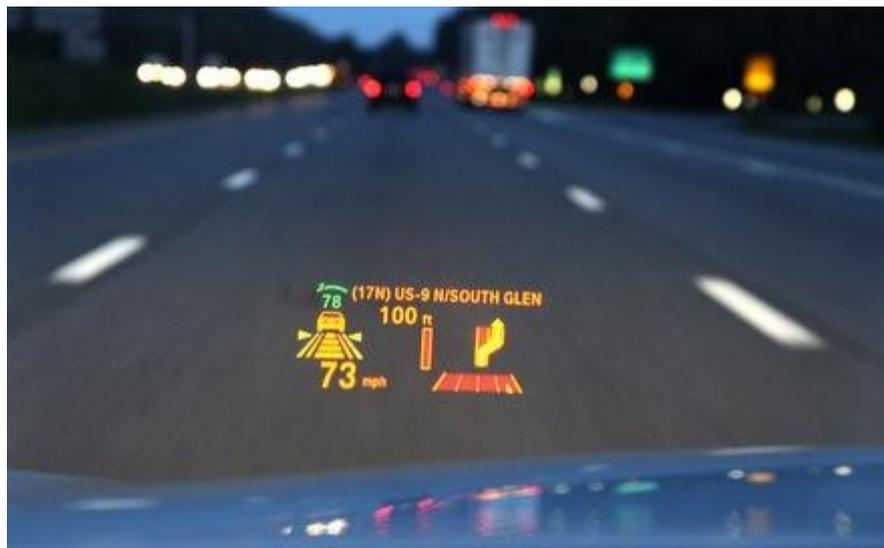
Figure 3. HUD de la BMW série 7. Affichage de la distance inter-véhicule, de la vitesse, et des instructions de navigation.
