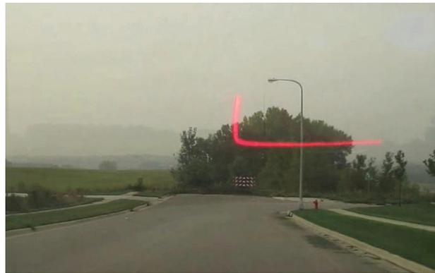
Figure 6. Prototype du Virtual Cable™. Un faisceau laser simule un câble indiquant la voie à prendre.<sup>5</sup>
