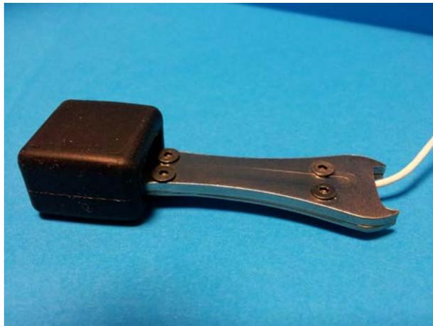
*Figure 2.18 : Capteur de force occlusal avec son enveloppe à usage unique.*
