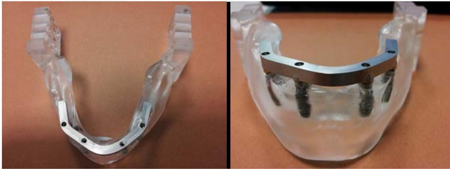
Figure 4.20 : Barre usinée transviscée sur la mandibule artificielle.
