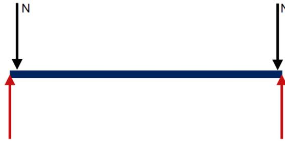
Figure A2-15 : Représentation de la sollicitation de l'axe de pivotement
