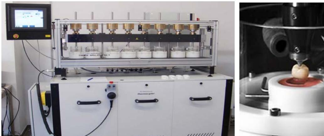
*Figure 4.2 : Chewing simulator de SD Mechatronik (à gauche : vue globale; à droite : détail).*
