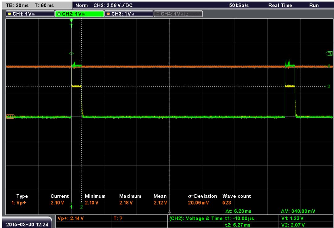
Figure VI-3 : Sorties des trois régulateurs de tension observées à l'oscilloscope, V_{bat} = 3.3V , T_{ambiante}
