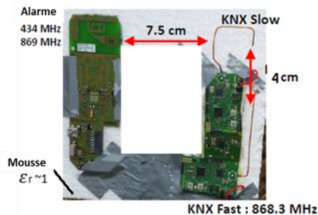
Figure IV-18 : Support physique de la box domotique utilisée dans les tests expérimentaux
