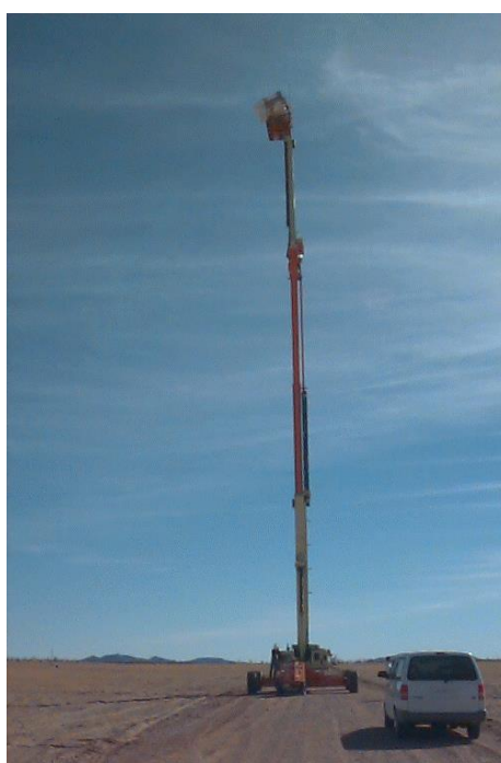
Fig. I.9 – Le système radar BOOMSAR
