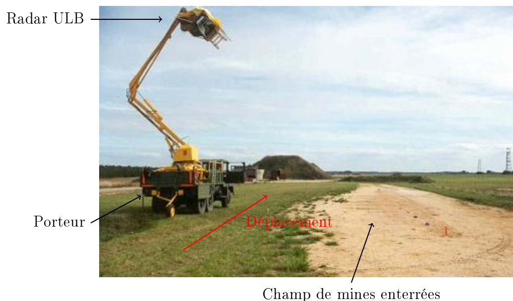
Fig. I.8 – Le système radar PULSAR
