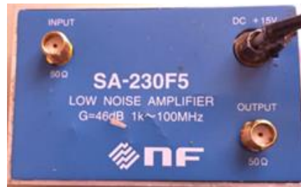
Figure 22: Amplificateur de tension faible bruit modèle SA-230F5
